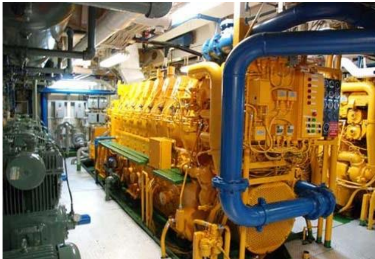
Κύρια Μηχανή Πλοίου Ντίτζελ Δίχρονη
