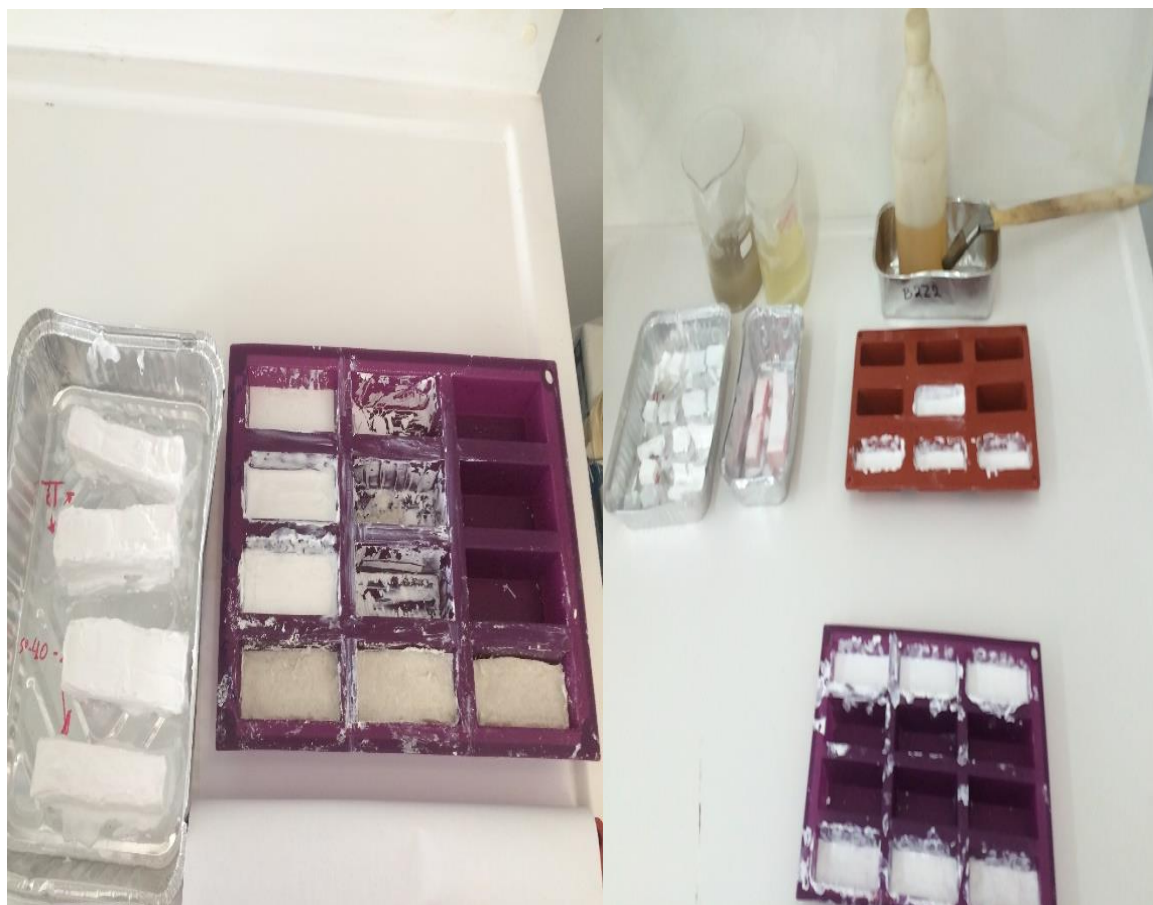
Σχήμα 2.10.: Εικόνες από την τοποθέτηση του υλικού στα καλούπια μορφοποίησης
