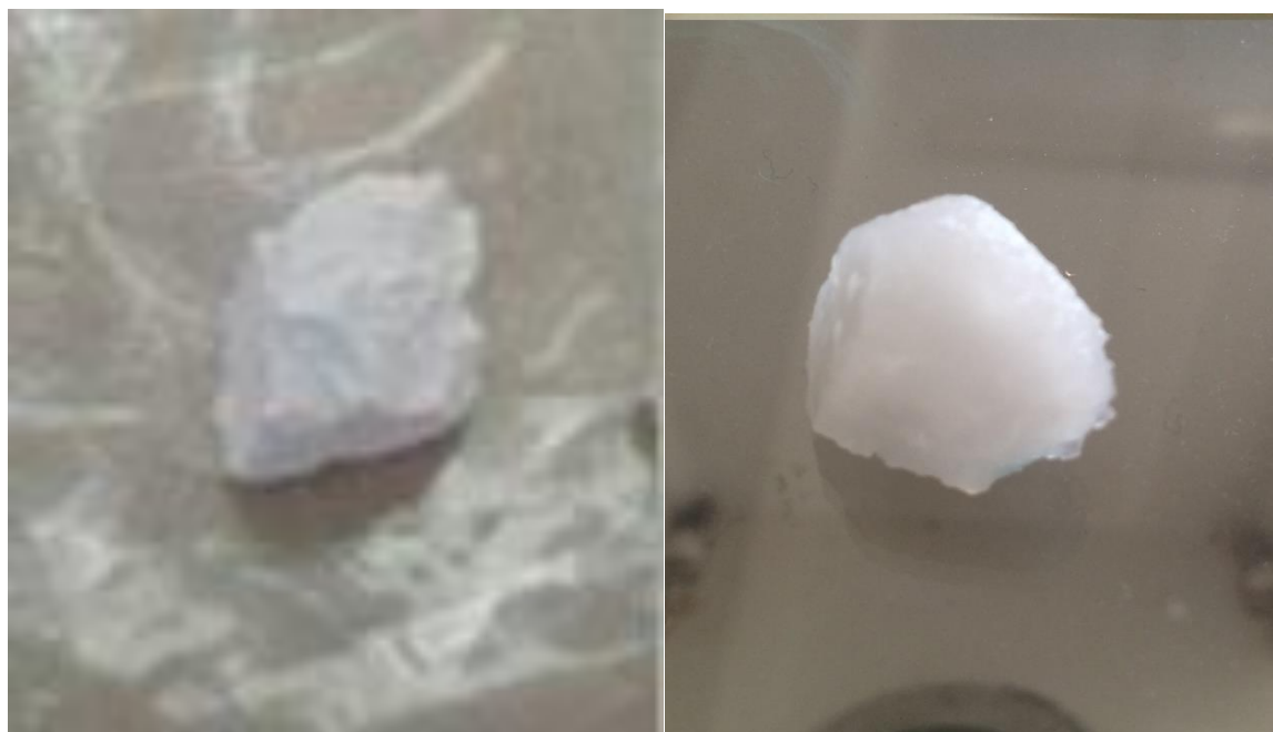
Σχήμα 2.23.: Κεραμικός αφρός που προέκυψε από αρχική ανάμιξη 20% υδροξυαπατίτη- 10% γυαλί μετά από θέρμανση στους 1050 ° C πριν και μετά την τοποθέτησή του στο γαστρικό υγρό
