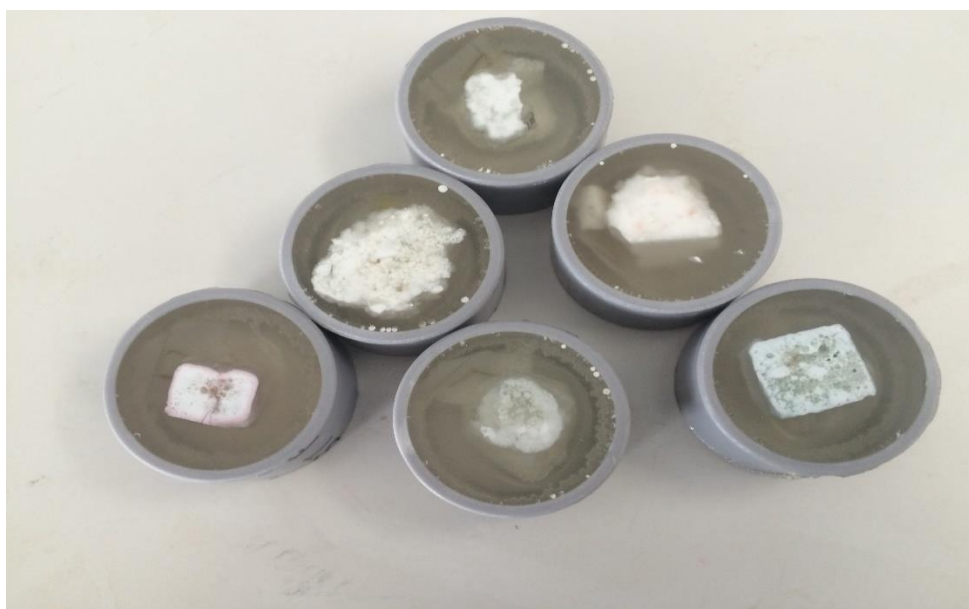
Σχήμα 2.20.: Τα προς μελέτη δείγματα σε κατάλληλη μήτρα με ειδική κόλλα πριν τη μέτρηση της μικροσκληρότητας
