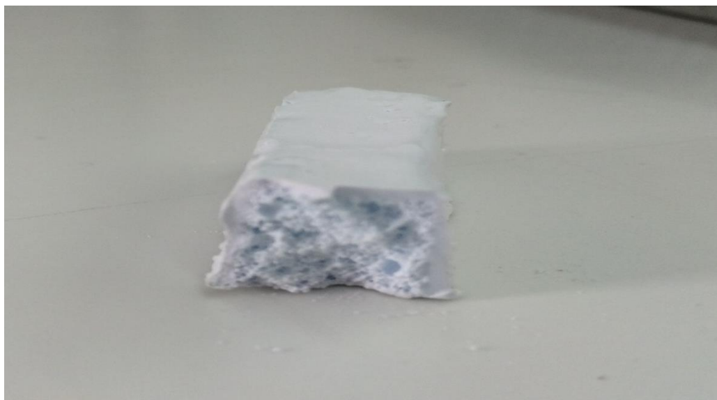
Σχήμα 2.13.: Κεραμικός αφρός που έχει παρασκευαστεί με την τεχνική της απλής χύτευσης, σε θερμοκρασία έψησης 1250 °C
