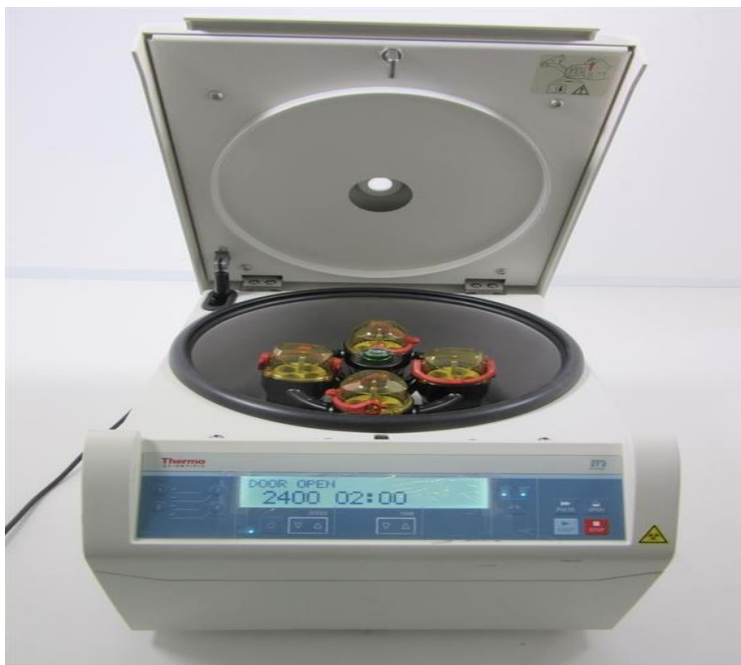
Σχήμα 2.9.: Φυγόκεντρος τύπου Thermo Scientific ST8
