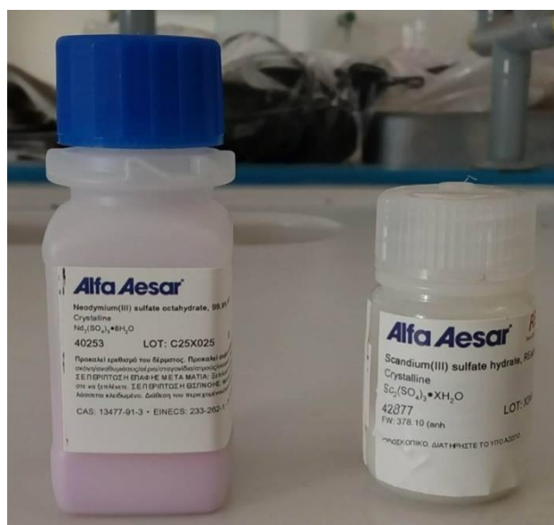
Εικόνα 3.1: Τα αντιδραστήρια των σπανίων γαίων: οκταένυδρο θειικό νεοδύμιο (αριστερά) και ένυδρο θειικό σκάνδιο (δεξιά).
