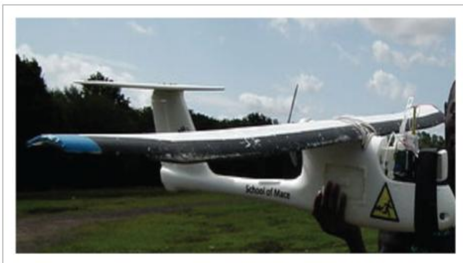
Εικόνα 22: Ολοκληρωμένο το σύστημα συσκευής ozonesonde-Skywalker drone. [8]
