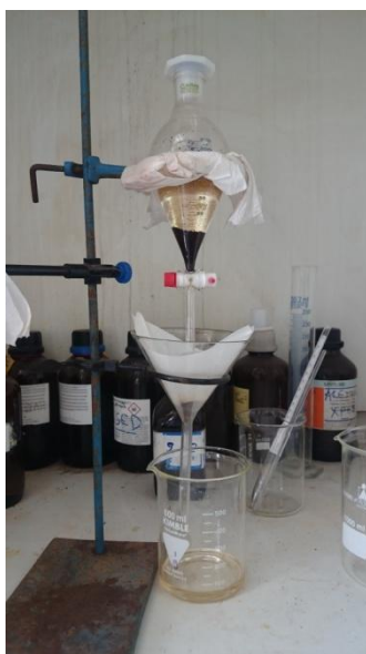
Σχήμα 3.6: Τμήμα διάταξης βαρυτομετρικού διαχωρισμού, το σκουρόχρωμο υλικό είναι το βαρύ προϊόν (SINK).
