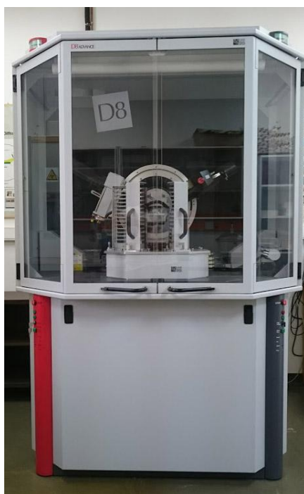
Σχήμα 3.1: Περιθλασίμετρο ακτίνων-X του Εργαστηρίου Γενικής και Τεχνικής Ορυκτολογίας του Πολυτεχνείου Κρήτης.
