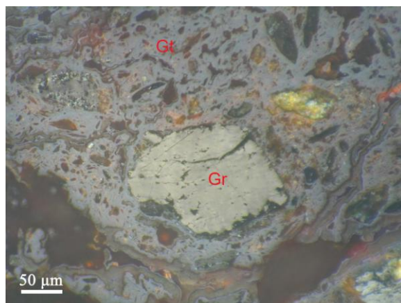
Σχήμα 4.11: Συμπαγής μάζα γκαιίτη (Gt) και μεμονωμένος κρύσταλλος γραφίτη (Gr). Δείγμα ΡΔ4, Ελαιοκατάδυση, // Nicols.
