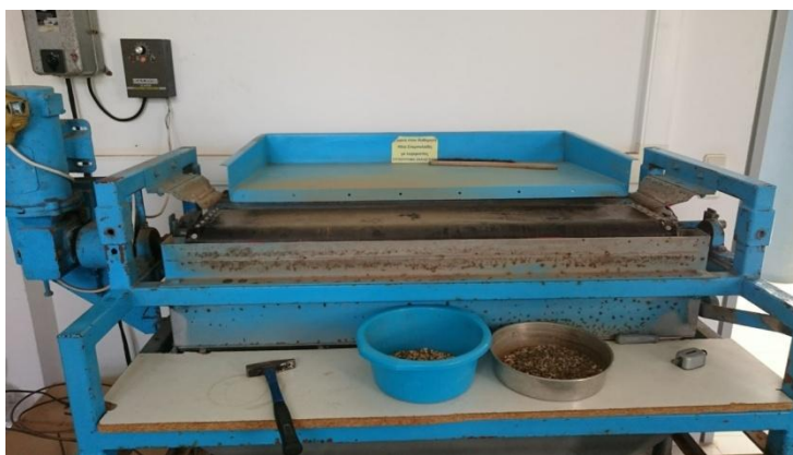
Σχήμα 3.7: Ταινιοφόρος μαγνητικός διαχωριστής (perm roll).
