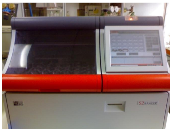
Σχήμα 3.4: Φασματοσκόπιο ακτίνων-X φθορισμού του Εργαστηρίου Ανόργανης Γεωχημείας, Οργανικής Γεωχημείας και Οργανικής Πετρογραφίας του Πολυτεχνείου Κρήτης.
