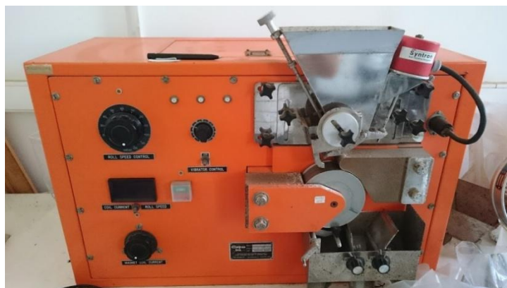
Σχήμα 3.8: Ξηρός μαγνητικός διαχωριστής υψηλής έντασης (high intensity induced magnetic separator Carpcο MIH 111-5).
