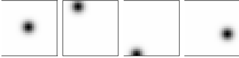
Σχήμα 2.2: Εκμάθηση ενός αυτο-οργανωτικού χάρτη με Gaussian μοτίβα δραστηριότητας. Κάθε είσοδος είναι ένα τέτοιο μοτίβο που διεγείρει τους νευρώνες γύρω από μια περιοχή του δικτύου. Τέσσερις διαφορετικές εισόδους φαίνονται στο σχήμα με την μόνη διαφορά να είναι η τοποθεσία τις διεγερμένης περιοχής κάθε φορά.
