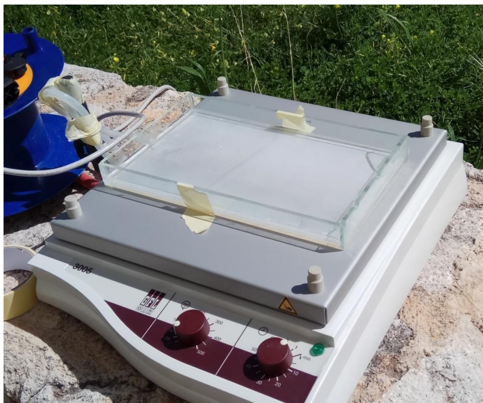
Εικόνα 13. Πειραματική διάταξη αντιδραστήρα σε συνθήκες ηλιακού φωτός
