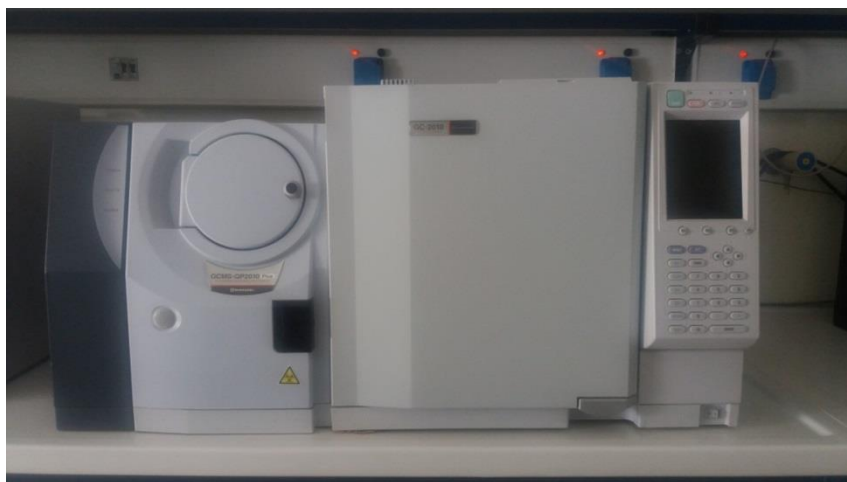
Εικόνα 3. 3: Αέριος χρωματογράφος - Φασματόμετρο μάζας υψηλής ανάλυσης εργαστηρίου (Gas Chromatography/Mass Spectrometry - GC/MS)
