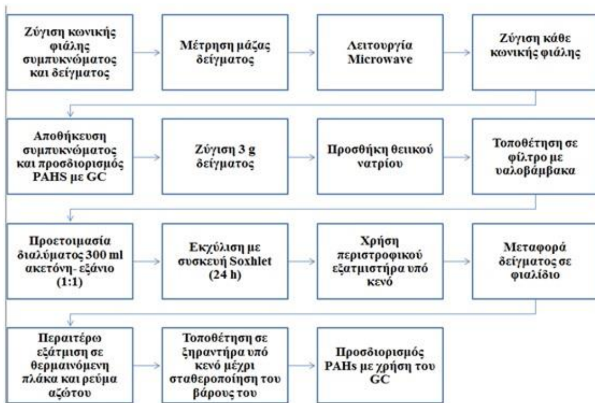
Διάγραμμα 3. 2: Διάγραμμα ροής επεξεργασίας δείγματος με θερμική εκρόφηση
