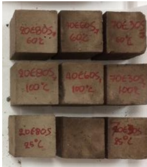
Εικόνα 11. Δοκίμια με πυρηνόξυλο
