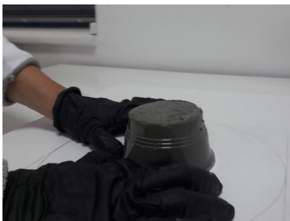
Εικόνα 12. Νωπό κονίαμα στην κωνική μήτρα εξάπλωσης
