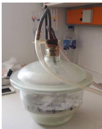
Εικόνα 15. Διαδικασία προσδιορισμού πορώδους υπό κενό αέρα
