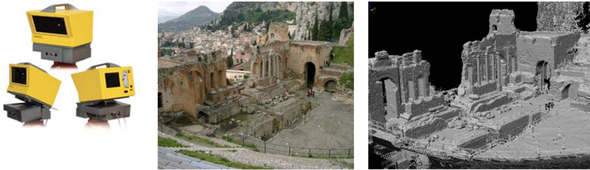
Σχήμα 1: Σαρωτής laser (Optech ILRIS 36D) και νέφος σημείων αντικειμένου πολιτιστικού ενδιαφέροντος
