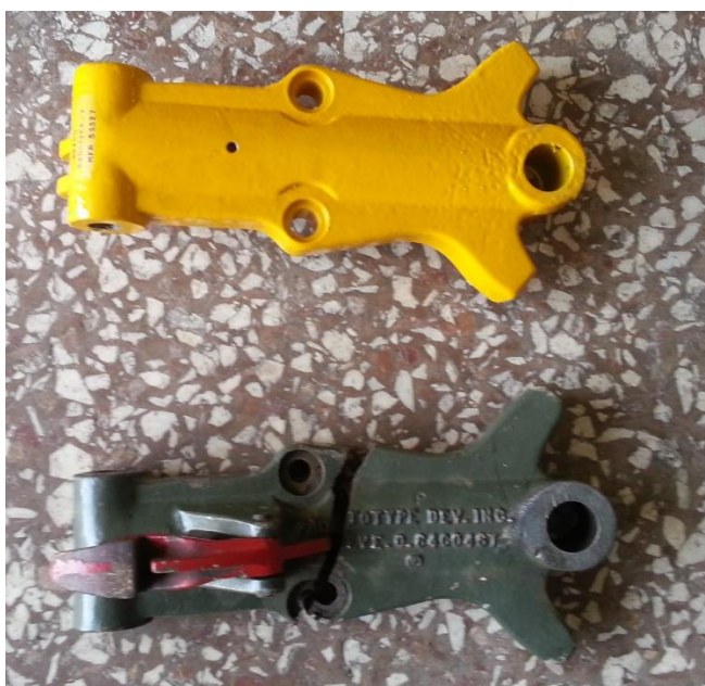
Σχημα 7.5: Σπάσιμο εξαρτημάτος κεντρικού βραχίονα συνδεσμολογίας.
