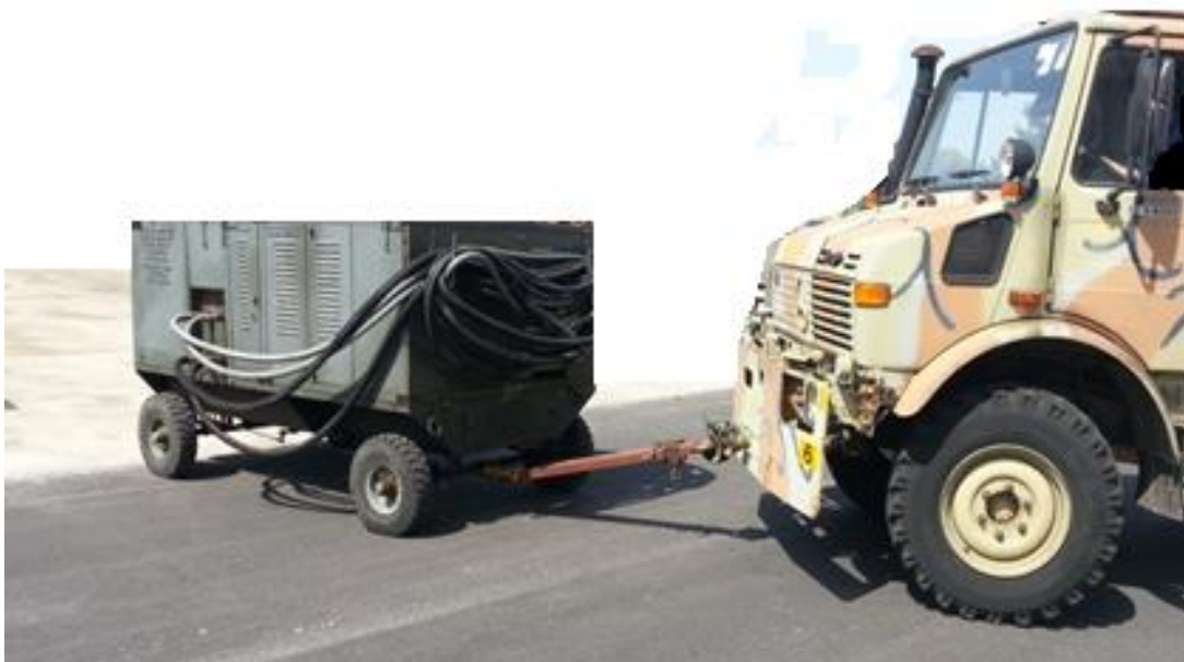
Σχήμα 3.1: Διαδικασία οπισθέλκησης συσκευής με μηχανοκίνητο όχημα.
