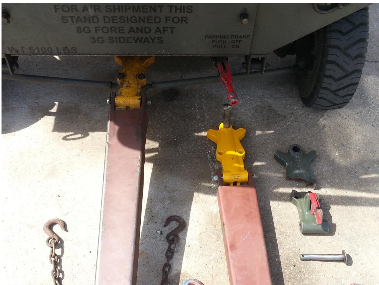
Σχήμα 1.1: Σύστημα ρυμούλκησης, στρεβλώσεις παραμορφώσεις και καταστροφή εξαρτημάτων
