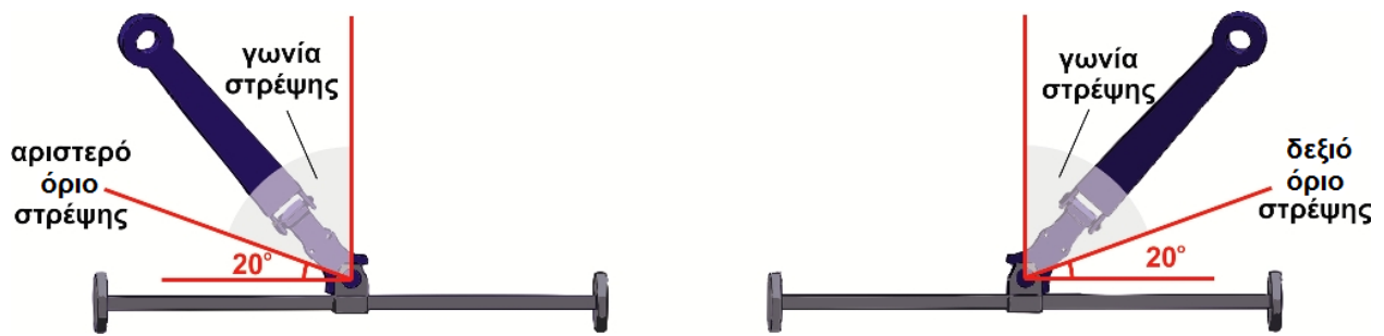
Σχήμα 3.12: Όρια γωνιών στρέψης συστήματος διεύθυνσης στο άξονα x
