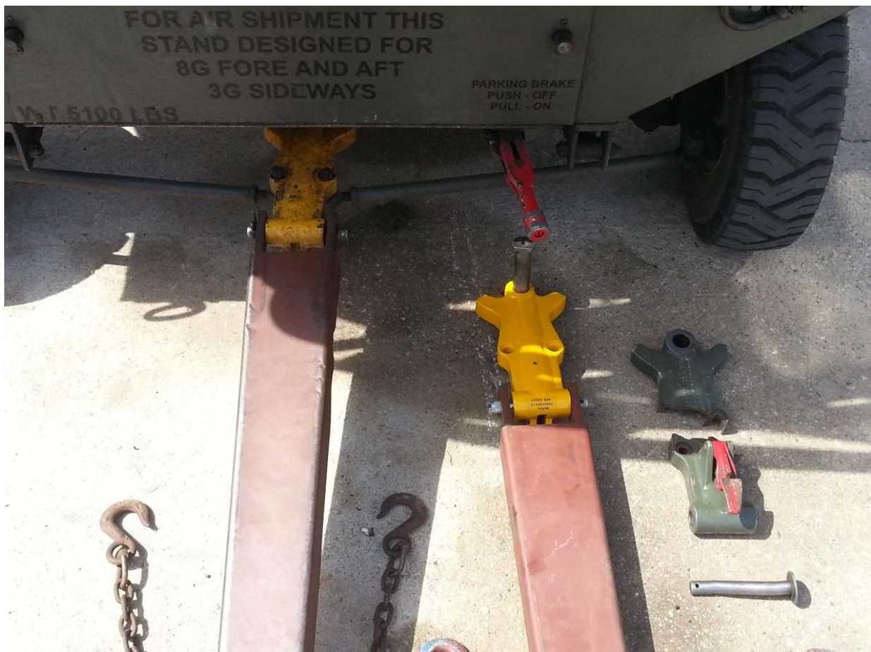
Σχήμα 7.6: Στρεβλώσεις της μπάρας ρυμούλκησης.
