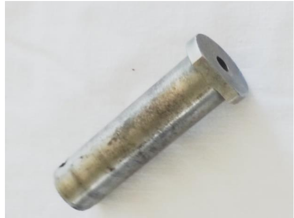
Σχήμα 3.9: Πείρος περιστροφής συγκροτήματος βραχίονα
