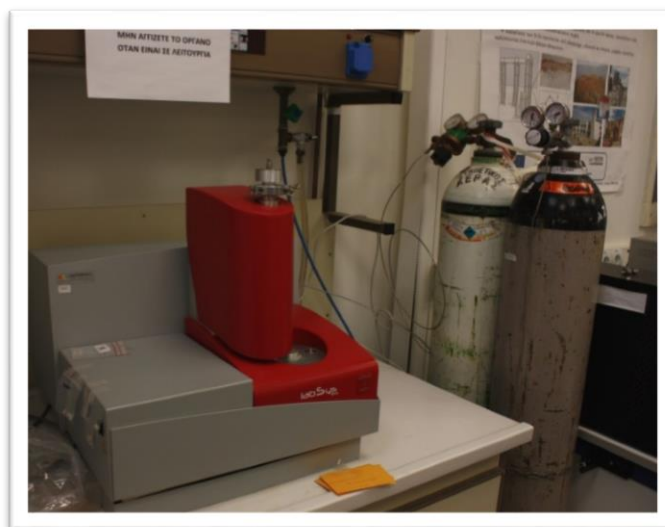
Φωτογραφία 2: Όργανο θερμικής ανάλυσης του εργαστηρίου «Υλικών Πολιτιστικής Κληρονομιάς και Σύγχρονης Δόμησης».
