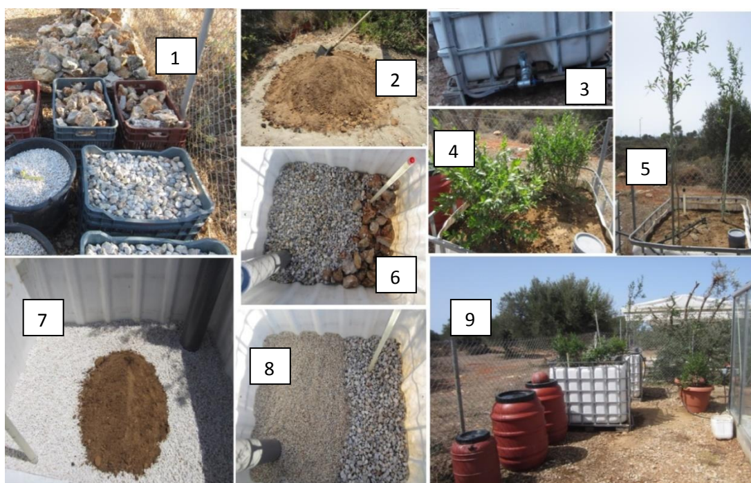
Εικόνα 15 Στάδια κατασκευής πειραματικών μονάδων φυτοαποκατάστασης ( 1 κροκαλοειδή, 2 μίγμα χώματος, 3 αλφαδολαστιχο, 4 Myrtus communis , 5 punica granatum , 6-7-8 κάτοψη μονάδας κατά την πλήρωση, 9 άποψη πειραματικών μονάδων φυτοαποκατάστασης)
