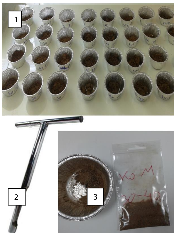
Εικόνα 23 Επεξεργασία εδαφικών δειγμάτων (1,3, ταξινόμηση εδαφικών δειγμάτων σύμφωνα με το αντίστοιχο βάθος, 2 δειγματολήπτης (τύπου καρότο)
