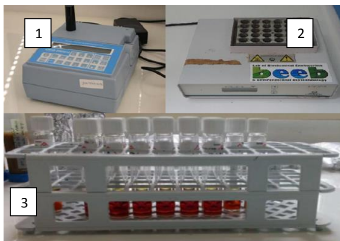
Εικόνα 22 Το φασματοφωτόμετρο (1) ο θερμοαντιδραστήρας (2) και τα έτοιμαφιαλίδια COD(3) που χρησιμοποιήθηκαν.
