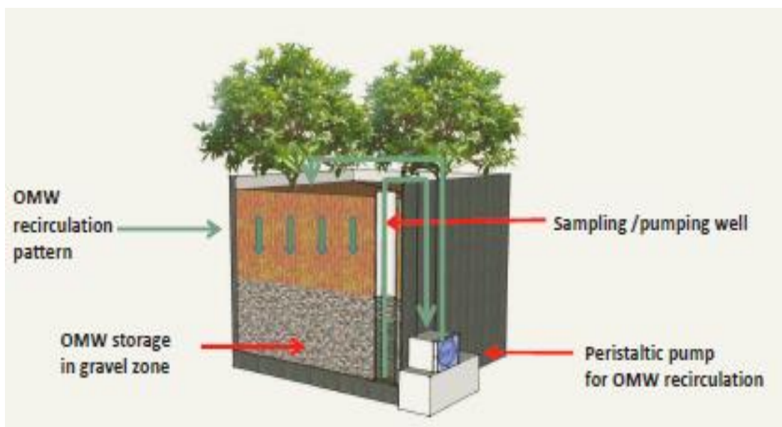
Εικόνα 17 Επανακυκλοφορία Υγρών Αποβλήτων Ελαιοτριβείου εντός της μονάδας φυτοαποκατάστασης.
