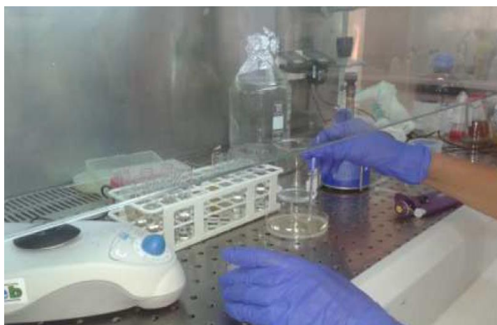
Εικόνα 24 Διαδικασία επιμόλυνσης τριβλίων petri για προσδιορισμό βακτηριακής βιομάζας σε δείγματα χώματος
