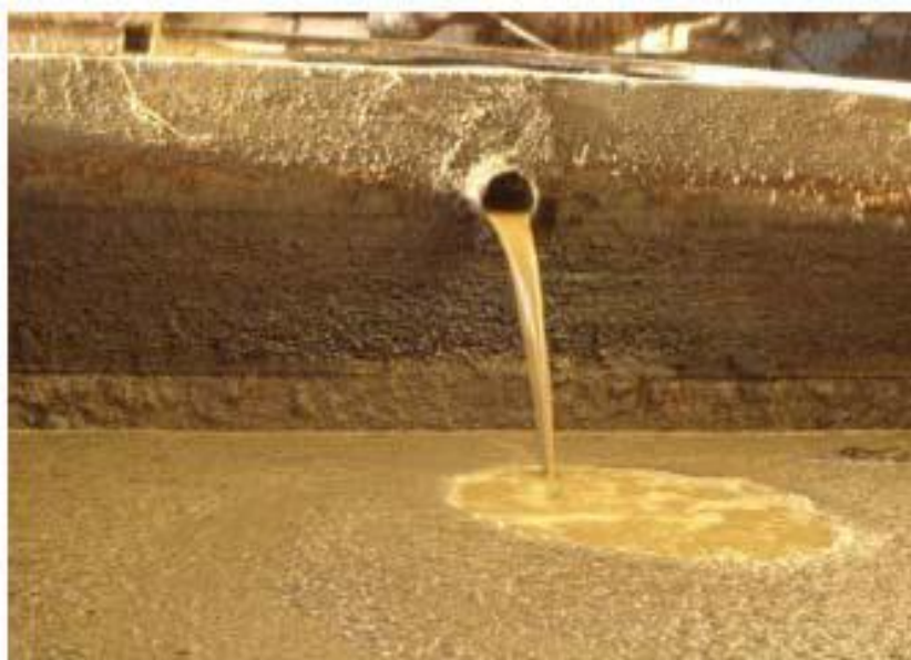
Εικόνα 7 Διαχείριση των υγρών αποβλήτων ελαιοτριβείου σε δεξαμενές καθίζησης.
