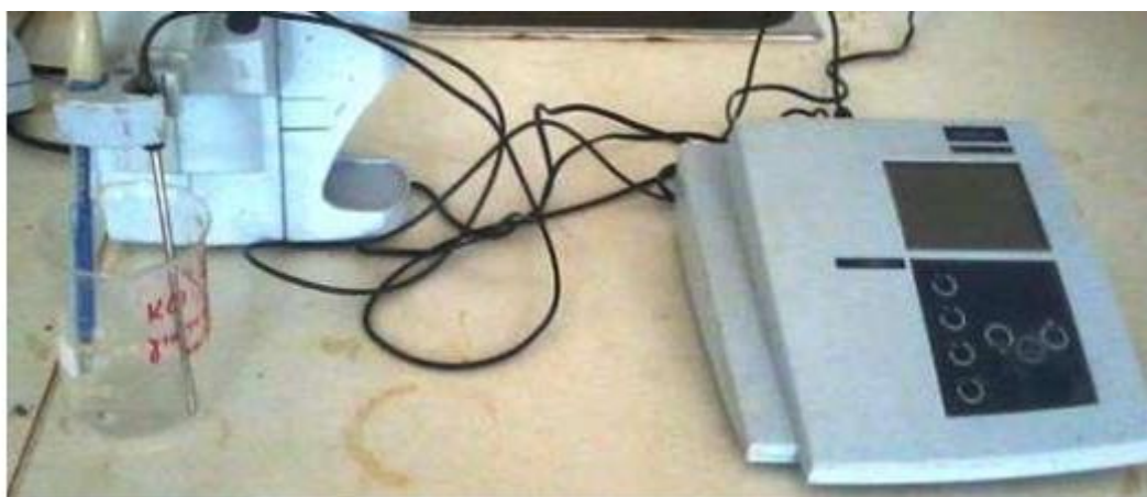
Εικόνα 3. Όργανο μέτρησης InoLab pH Level 1 WTW.
