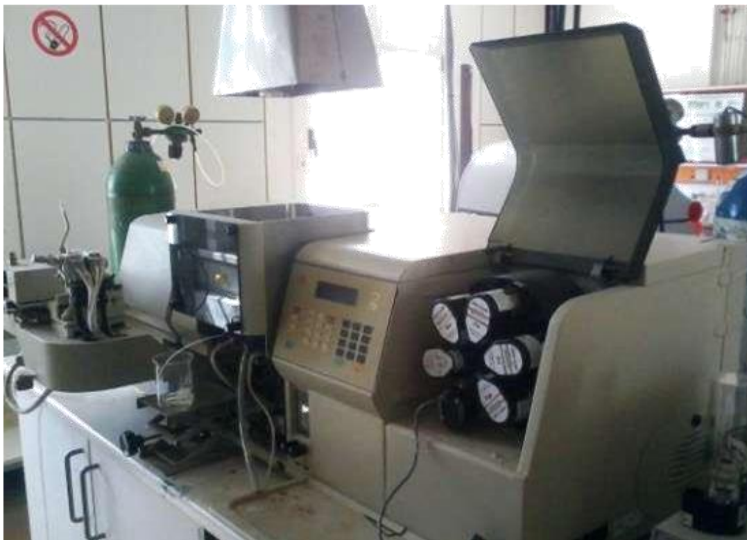
Εικόνα 2. Φασματοφωτόμετρο ατομικής απορρόφησης Analyst 100 Perkin Elmer.
