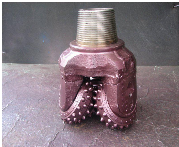
Εικόνα 7 Προωθητικός κοπτήρας Πηγή( http://autoline.de/sf/Ersatzteile-Bohrkrone-Tricone-Rock-Bits--1509041339276335400.html )
