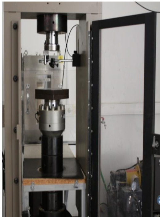
Εικόνα 3.11: Συσκευή μέτρησης αντοχής σε μονοαξονική θλίψη
