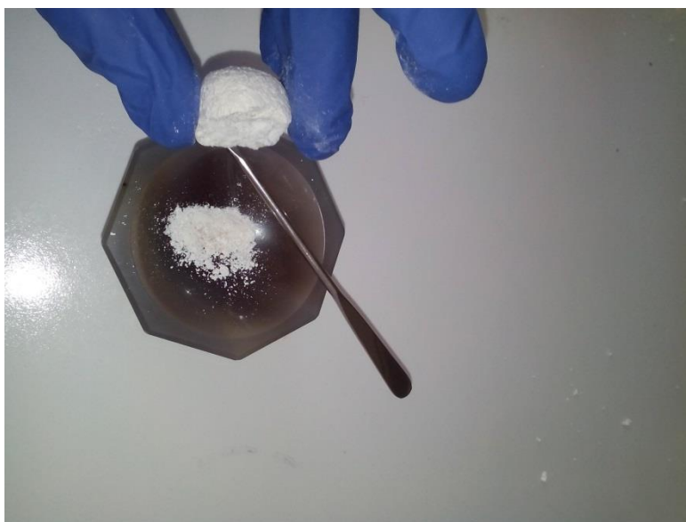
Εικόνα 3.5: Λήψη δείγματος από το εσωτερικό της πάστας για την θερμική ανάλυση
