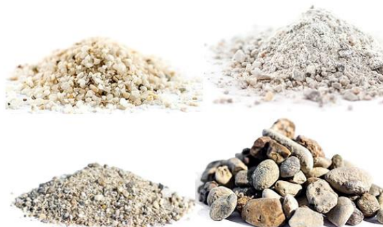
Εικόνα 3.2: Αδρανή διαφορετικής σύστασης και κοκκομετρίας
