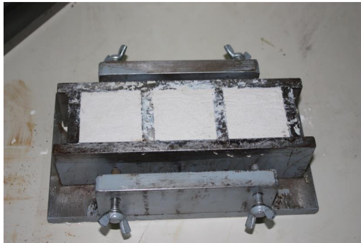
Εικόνα 3.10: Μήτρα για χύτευση δοκιμίων θλίψης
