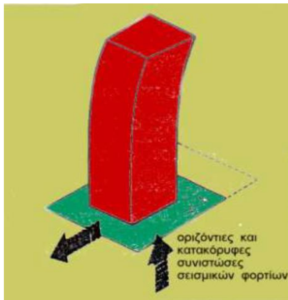
Σχήμα 4. Οριζόντιες και κατακόρυφες συνιστώσες σεισμικών φορτίων.
