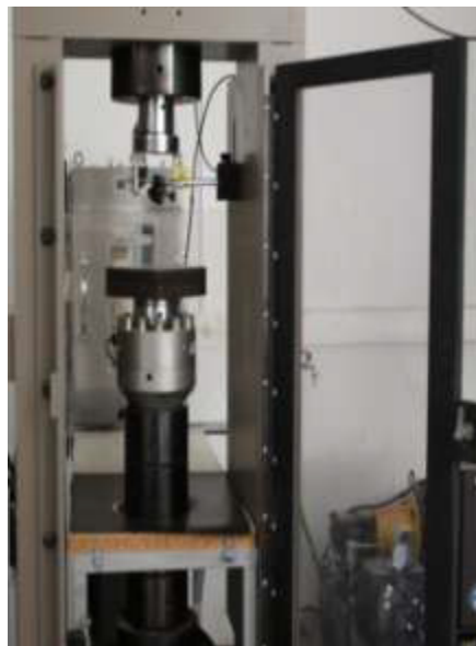
Εικόνα 4: Διάταξη συσκευής μέτρησης αντοχής σε μονοαξονική θλίψη
