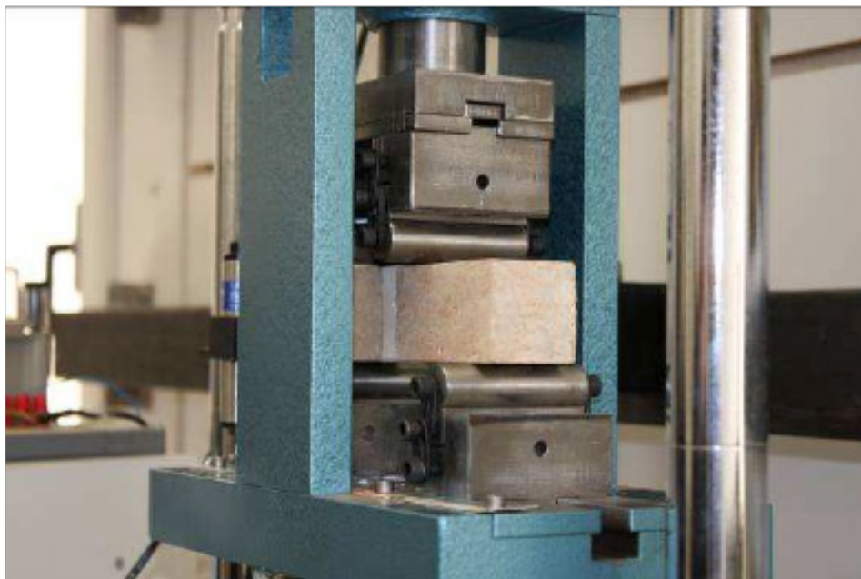
Εικόνα 5: Συσκευή Κάμψης 4 σημείων
