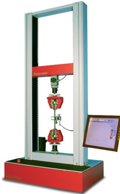
Σχήμα 4.1: Μηχανή εφελκυσμού-θλίψης Testometric M500-50 AT
