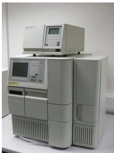
Εικόνα 20: Συσκευή υγρού χρωματογράφου υψηλής πίεσης HPLC και ανιχνευτής Diode Array 2996 PDA Detector.
