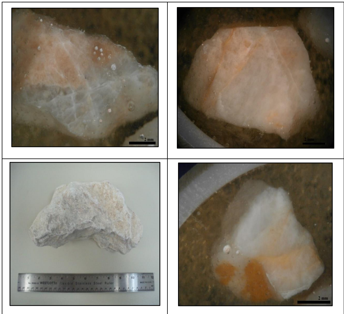
Εικόνα 4.6: Μακροσκοπικό τεμάχιο και φωτογραφίες στιλπνών τομών του δείγματος Α6.
