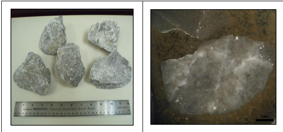
Εικόνα 4.2: Μακροσκοπικά τεμάχια και φωτογραφία στιλπνής τομής του δείγματος Α2.
