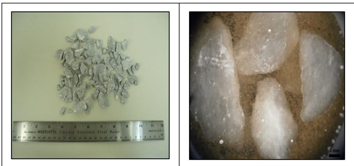
Εικόνα 4.3: Μακροσκοπικά τεμάχια και φωτογραφία στιλπνής τομής του δείγματος Α3.
