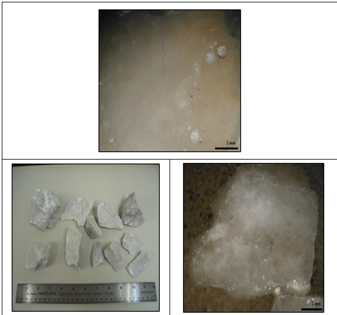
Εικόνα 4.5: Μακροσκοπικά τεμάχια και φωτογραφίες στιλπνών τομών του δείγματος A5.
