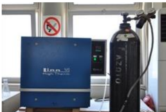
Εικόνα 4: Διάταξη πυρόλυσης (φούρνος-φιάλη αερίου Αζώτου)
