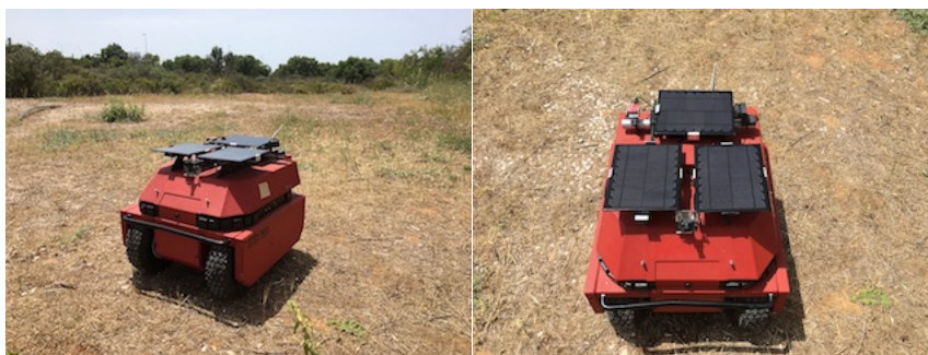
Εικόνα 3.6: Τοποθέτηση ηλιακών πάνελ στο ρομποτικό όχημα ATRV-mini
