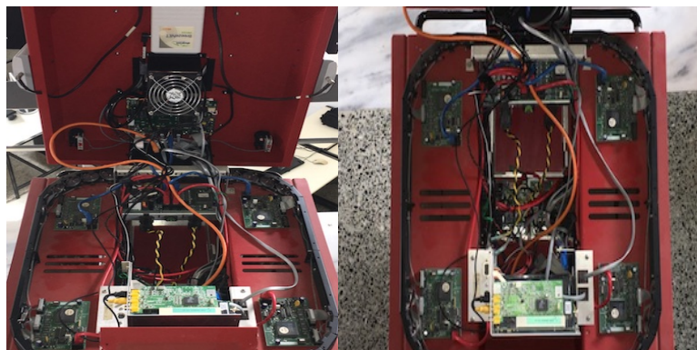
Εικόνα 2.9 : Εσωτερική όψη του ρομποτικού οχήματος ATRV-mini
