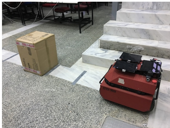
Εικόνα 4.4: Μέτρηση της απόστασης με το κεντρικό αισθητήριο μέτρησης απόστασης
