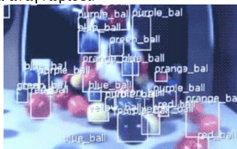
Εικόνα 3.12: Αισθητήριο εικόνας Pixy CMUcam5 αναγνώριση χρωμάτων
