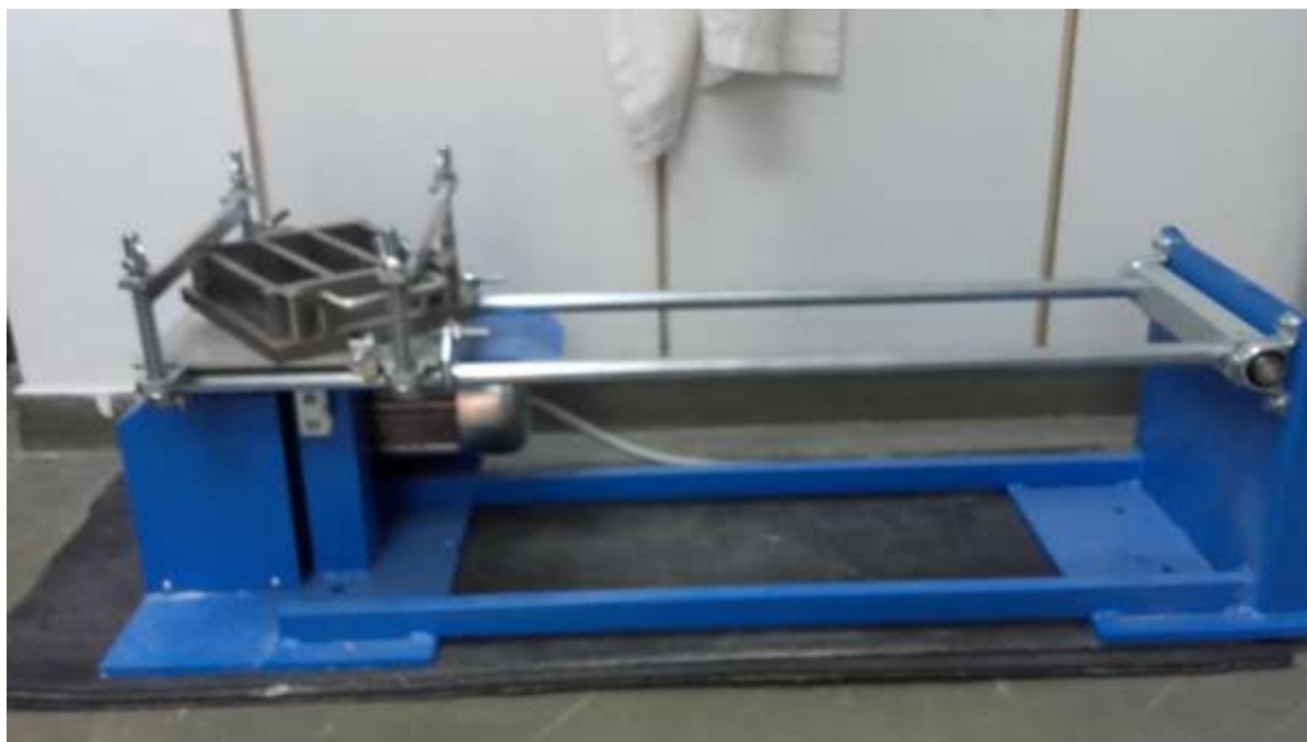
Εικόνα 11. Τράπεζα δόνησης MATEST Jolting apparatus E130 και πρισματικό καλούπι διαστάσεων 40 \times 40 \times 160 \text{ mm}^3
