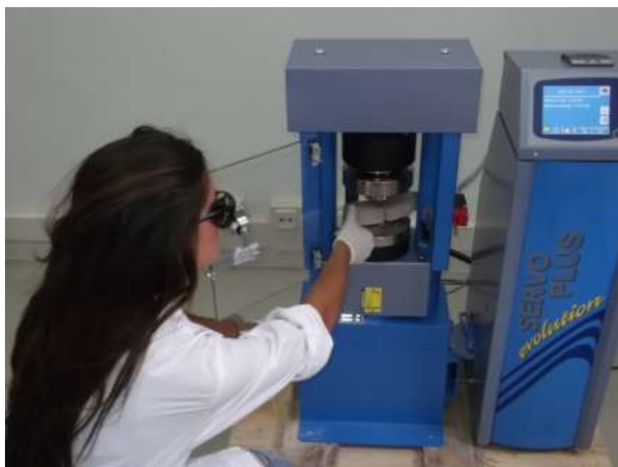
Εικόνα 15. Μηχανή μέτρησης αντοχής σε μονοαξονική θλίψη και κάμψη.
