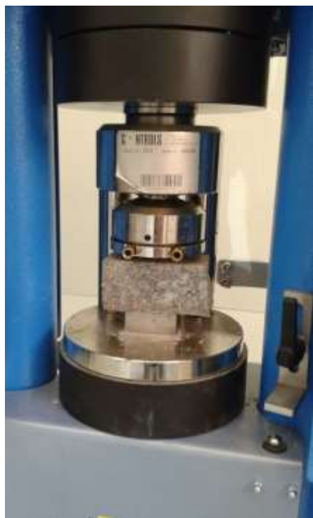
Εικόνα 14. Κελί φόρτισης για δοκιμή μονοαξονικής θλίψης.
