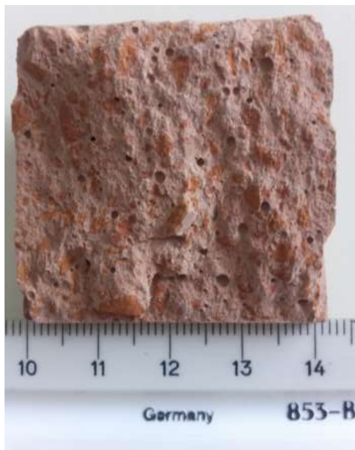
Εικόνα 21. Οπές διαφόρων μεγεθών λόγω των φυσαλίδων αέρα σε δοκίμιο της σύνθεσης C7.
