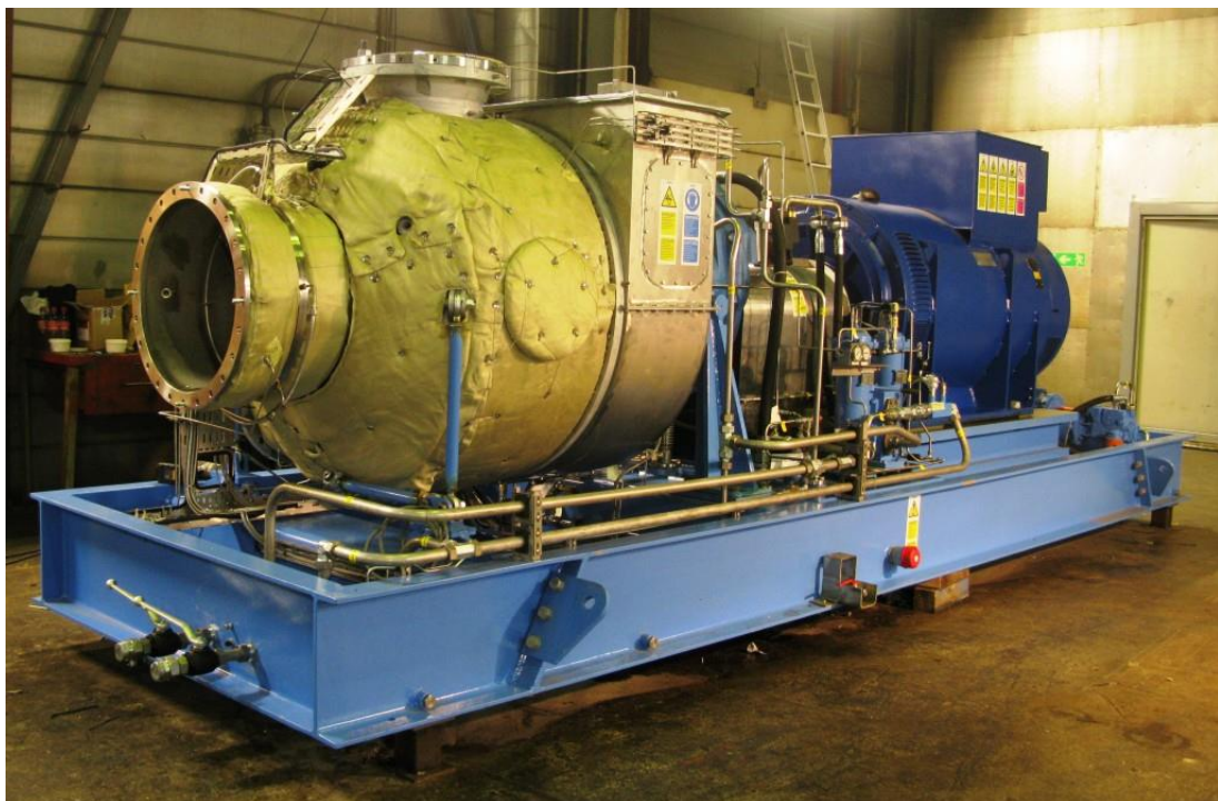
Εικόνα 2.9: Σταθμός Παραγωγής GO “Ener-Core KG2-3G” με AT 2 MW (ENER-CORE, 2017)
