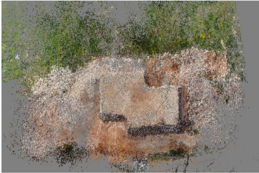
Εικόνα 4.10: Το νέφος σημείων της τελικής εκσκαφής.
