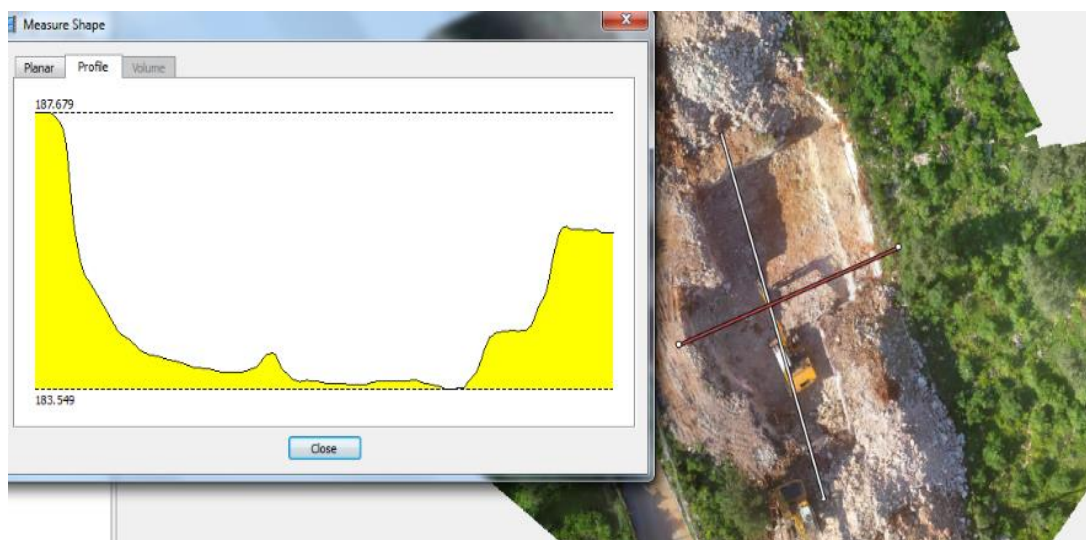
Εικόνα 4.30: Υπολογισμός τομής αρχικού σκάμματος μέσω λογισμικού.
