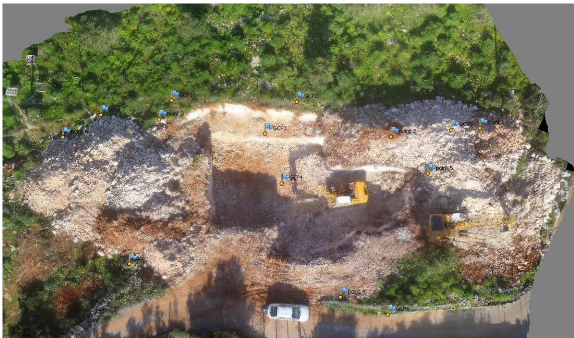
Εικόνα 4.16: Η αρχική κατάσταση με όλα τα GCPs.
