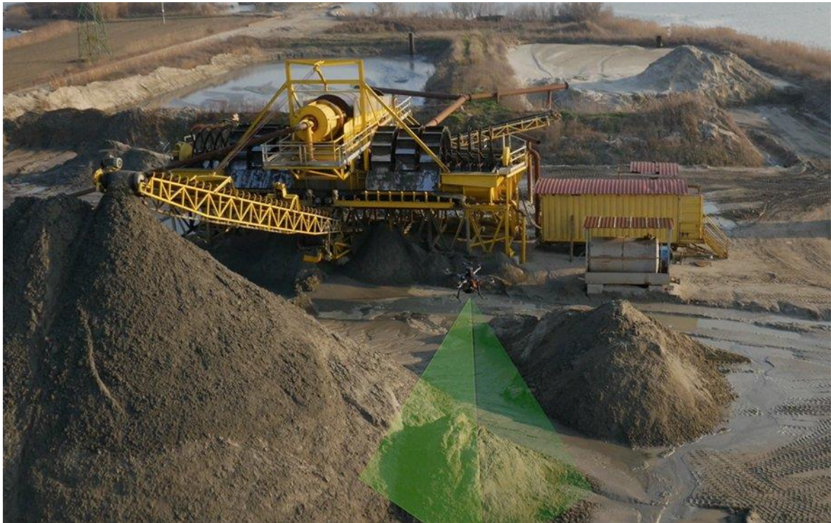
Εικόνα 2.4: Φωτογραμμετρική αποτύπωση με UAV για υπολογισμό όγκου.
