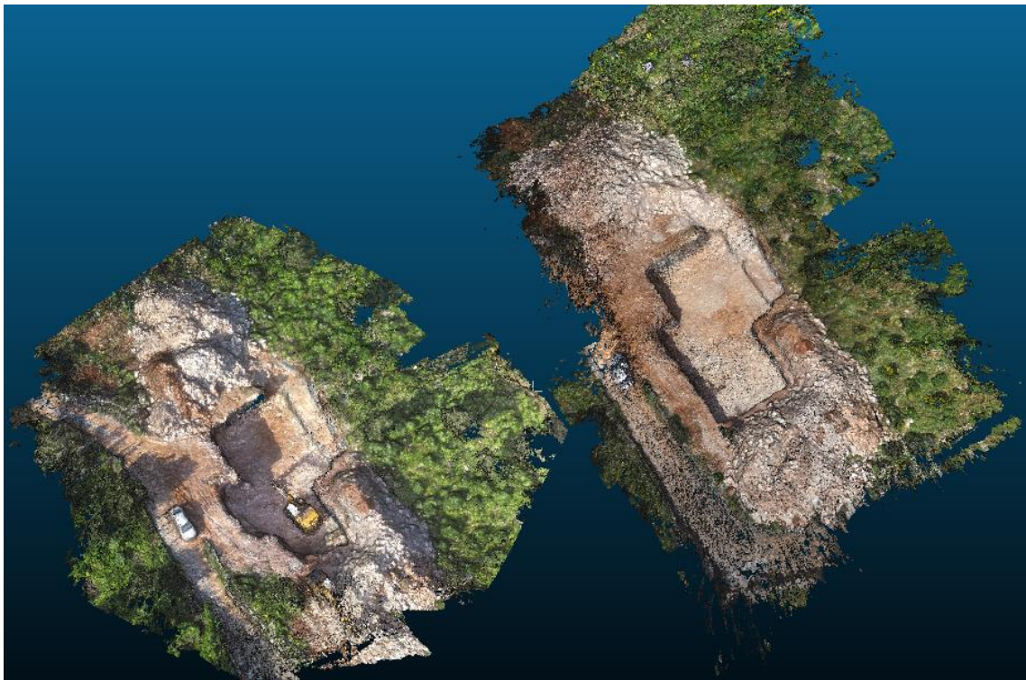
Εικόνα 4.21: Τα δύο μοντέλα σε μορφή νέφους σημείων.
