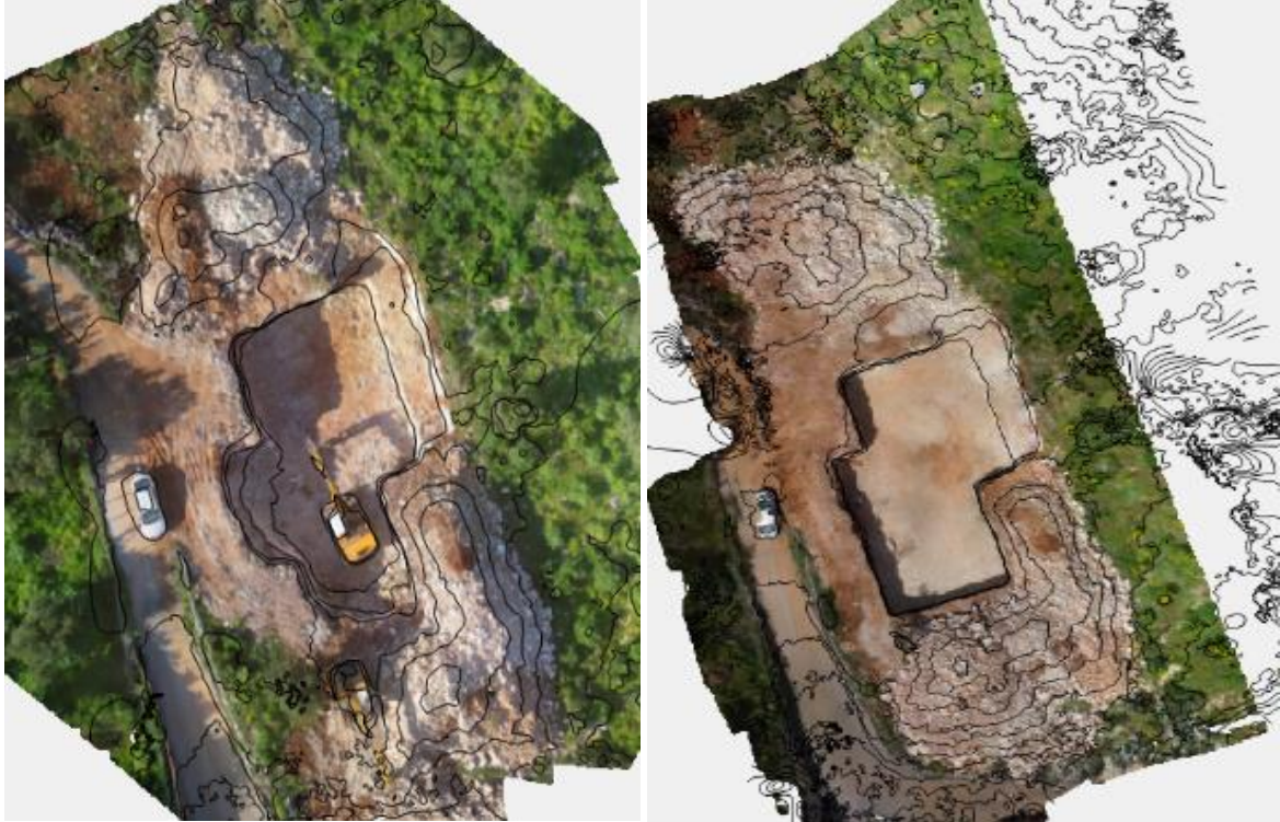
Εικόνα 4.19: Συνδυασμός πληροφορίας από ορθοφωτογραφίες και ισοϋψείς καμπύλες με ισοδιάσταση ενός μέτρου.
