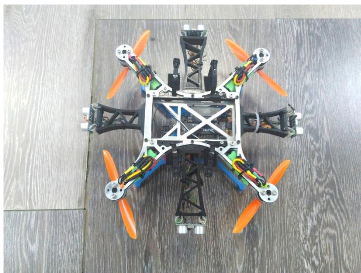
Εικόνα 3.4: UAV με κατάλληλους αισθητήρες για αποφυγή εμποδίων.
