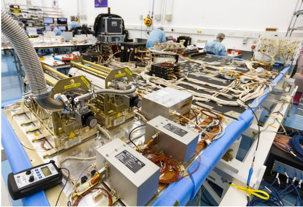
Εικόνα 2.7: Εξοπλισμός δορυφόρου πλοήγησης Galileo. Στο κέντρο φαίνονται τα δύο ατομικά χρονόμετρα ρουβιδίου (δεξιά) και τα δύο maser υδρογόνου (αριστερά). (ESA, 2015)
