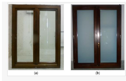
Εικόνα 2.4 Ξύλινο πλαίσιο με (a): συμβατικό υαλοστάσιο, (b): με αερογέλη μεταξύ των στρώσεων γυαλιού (Buratti, Moretti, & Zinzi, 2017)
