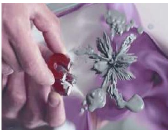
Εικόνα 1.4 Μαγνητορρολογικό ρευστό υπό την επίδραση μαγνητικού πεδίου υφίσταται σκλήρυνση
