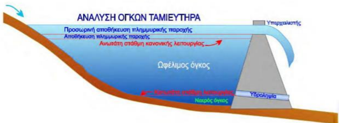
Εικόνα 3: Φράγμα και ανάντη ταμιευτήρα (Βαφειάδης Σημειώσεις «Ταμιευτήρες» )
