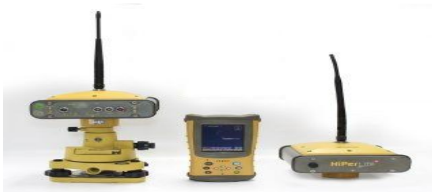
[Εικόνα 69: Ο εξοπλισμός του RTK GPS]
