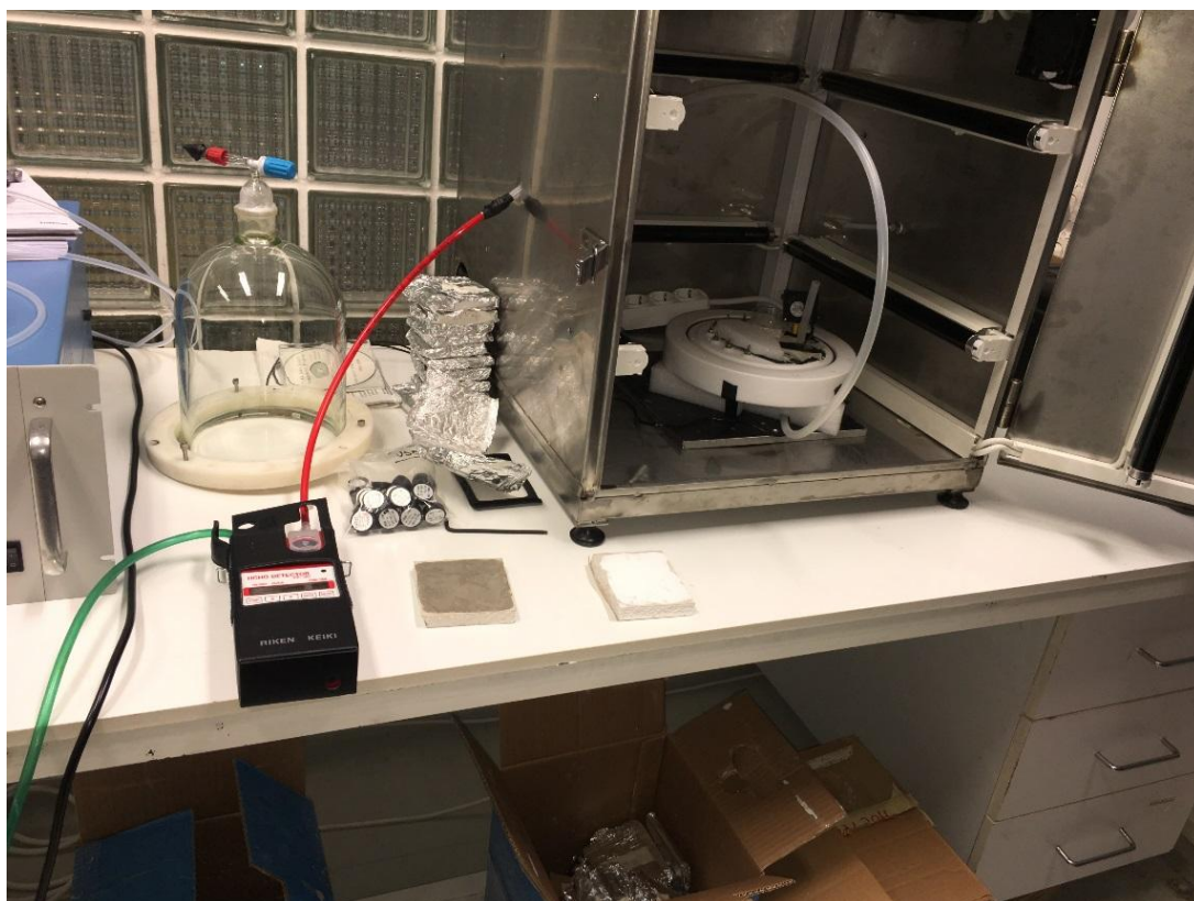
Εικόνα 3.13 Ολοκλήρωση πειραματικής διαδικασίας : χρησιμοποιημένα φίλτρα , δομικά υλικά , γυάλινος και αλουμινένιος θάλαμος με ξεκάθαρη συνδεσμολογία, ανιχνευτής φορμαλδεΰδης συνδεδεμένος με τον θάλαμο με το κόκκινο καλώδιο, ενώ το πράσινο καλώδιο συνδέεται με τον απαγωγό αερίων του εργαστηρίου.
