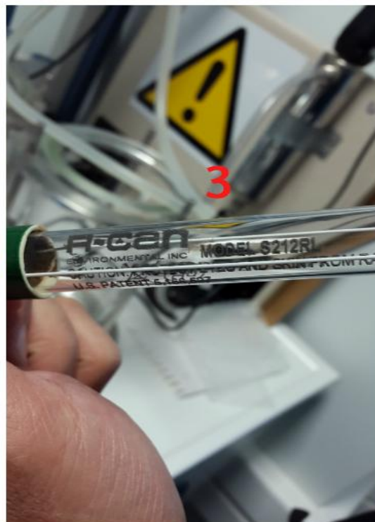
Εικόνα 4.3: Σύστημα απολύμανσης υπεριώδους ακτινοβολίας (UV-C): 1. Αντλία ISMATEC, Type : MCP V.5.12 μεταβλητής παροχής, 2. Σωληνάκι συλικονούχο για την μεταφορά του αποβλήτου στη συσκευή απολύμανσης, 3. Λάμπα UV μήκους κύματος \lambda = 254 \text{ nm} , LAMP ASSY (TUBED), ισχύος 10W , Model : S212RL, 4. Φωτιστικό σώμα λάμπας μάρκας sterilight copper,
