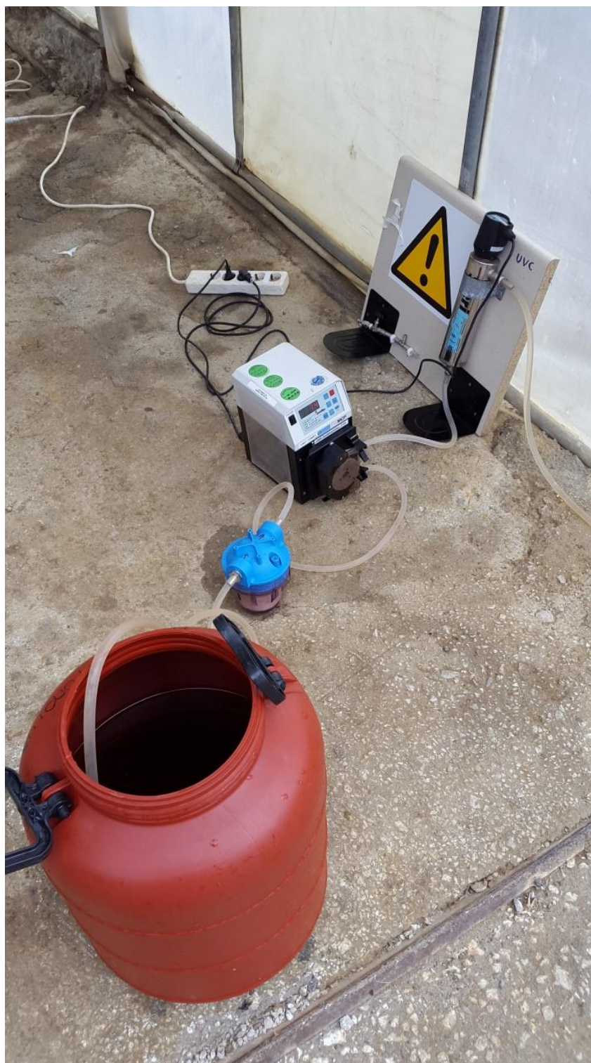
Εικόνα 4.8: Πειραματική διάταξη UV-C με φίλτρο στο θερμοκήπιο της Επισκοπής.
