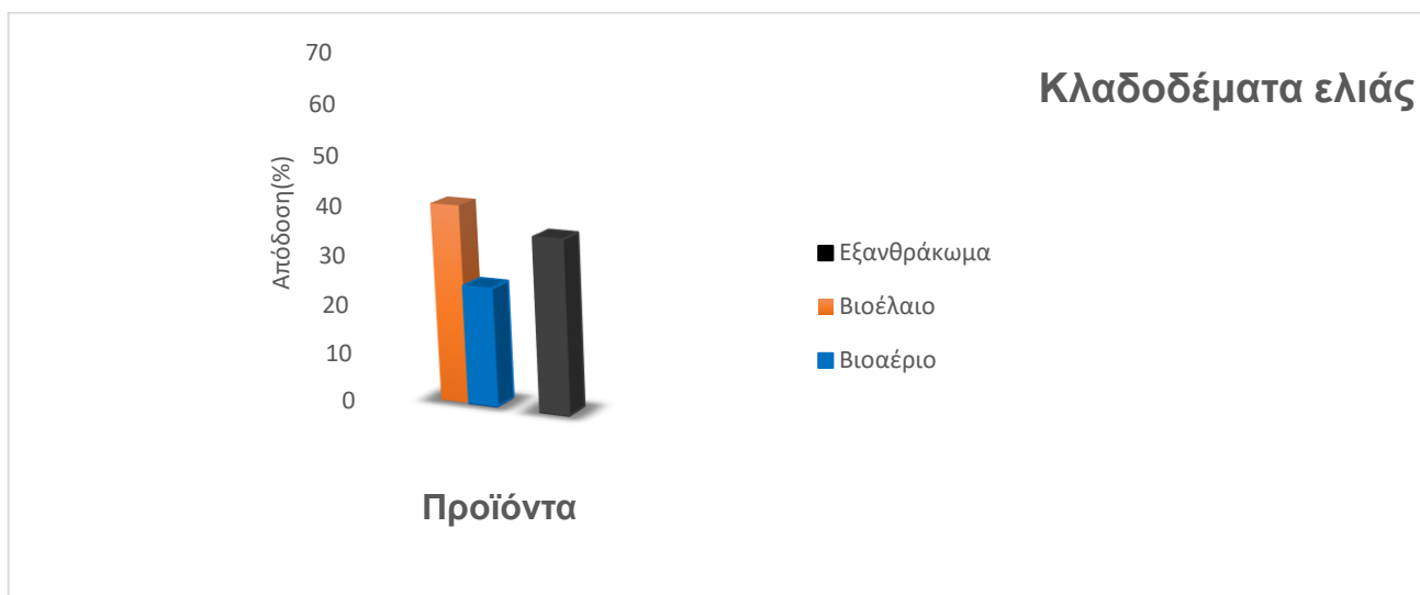
Διάγραμμα 4.22: Διάγραμμα απόδοσης σε βιοεξανθράκωμα, βιοέλαιο και βιοαέριο για το δείγμα Κλαδοδέματα ελιάς στους 400°C με χρόνο παραμονής 60 min.
