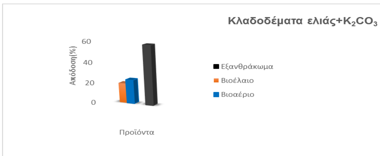
Διάγραμμα 4.23: Διάγραμμα απόδοσης σε βιοεξανθράκωμα, βιοέλαιο και βιοαέριο για το δείγμα Κλαδοδέματα ελιάς+K 2 CO 3 στους 400°C με χρόνο παραμονής 60 min.
