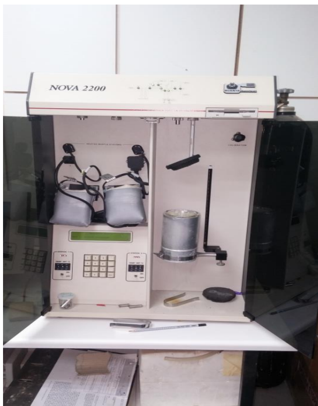
Εικόνα 3.13: Συσσκευή Nova 2200 της εταιρείας Quantachrome.
