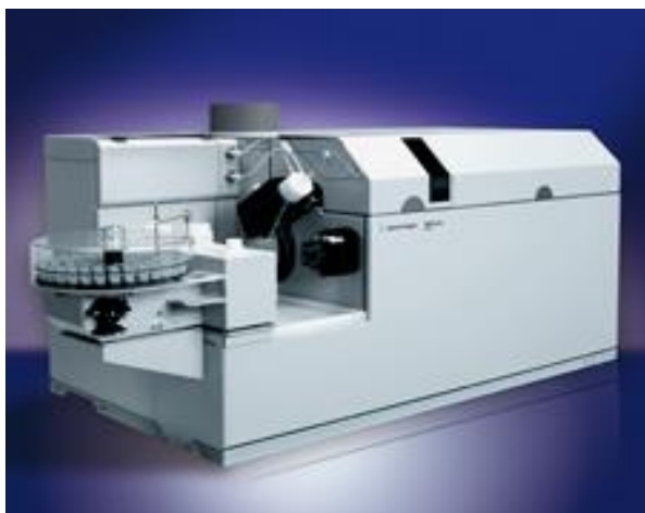
Εικόνα 3.12: α) ICP-MS 7500 cx, β) Αυτόματος δειγματολήπτης ASX-500.
