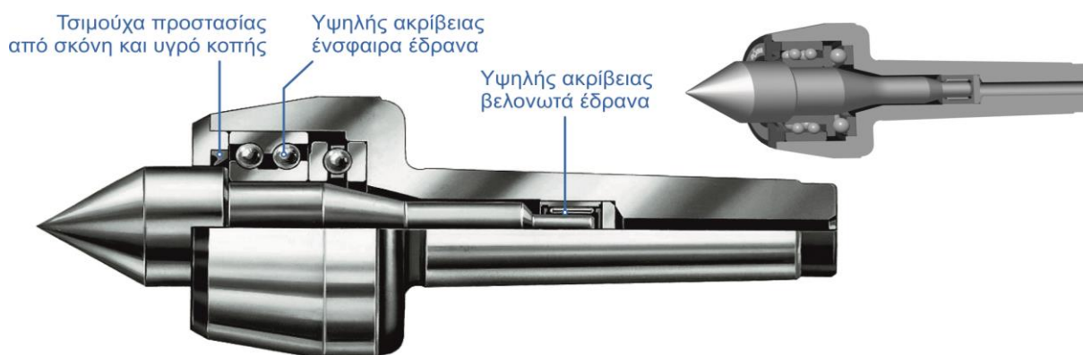
Σχήμα 3.3: Διάταξη σύγχρονου περιστρεφόμενου κεντροφορέα
