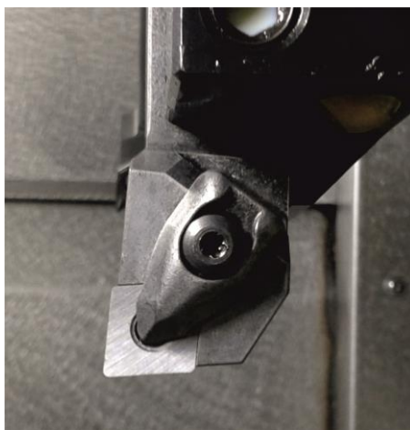
Σχήμα 3.4: Ένθετο πλακίδιο CNMA 120408
