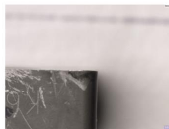
Μέτρηση μέγιστου πλάτους ζώνης φθοράς
