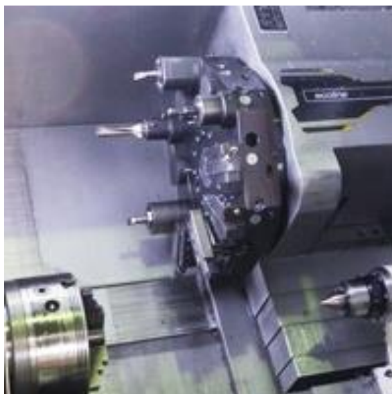
Σχήμα 3.2: Εργαλειοφορείο CTX 310 ecoline
