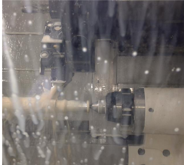
Σχήμα 3.10: Στιγμιότυπο κατά τη κατεργασία με χρήση του κεντροφορέα
