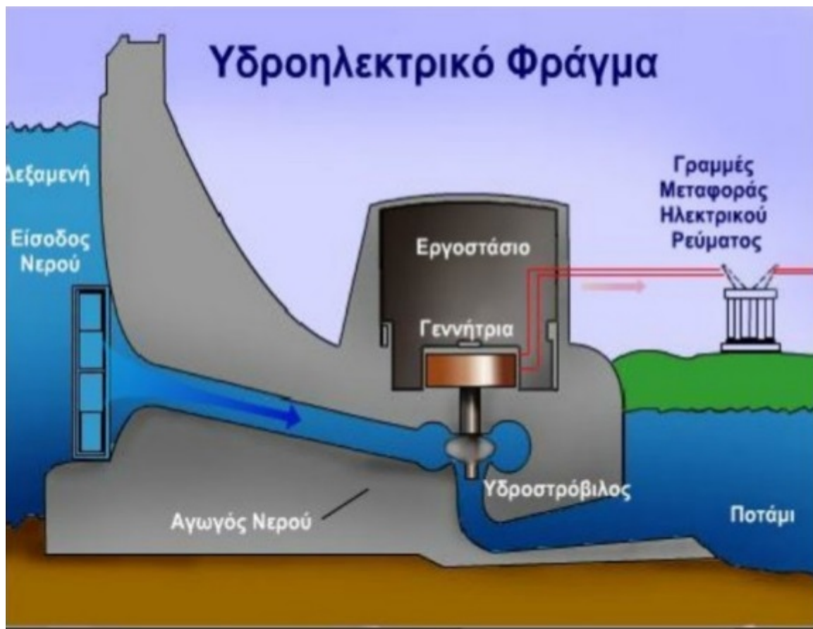
Εικόνα 2.2 : Ο τρόπος λειτουργίας ενός υδροηλεκτρικού σταθμού.
