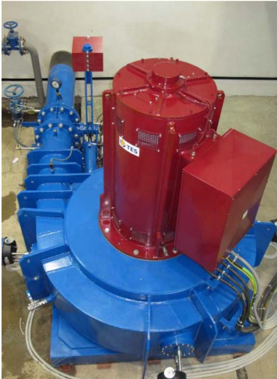
Εικόνα 4.2 : Υδροστρόβιλος Pelton κάθετου άξονα.
