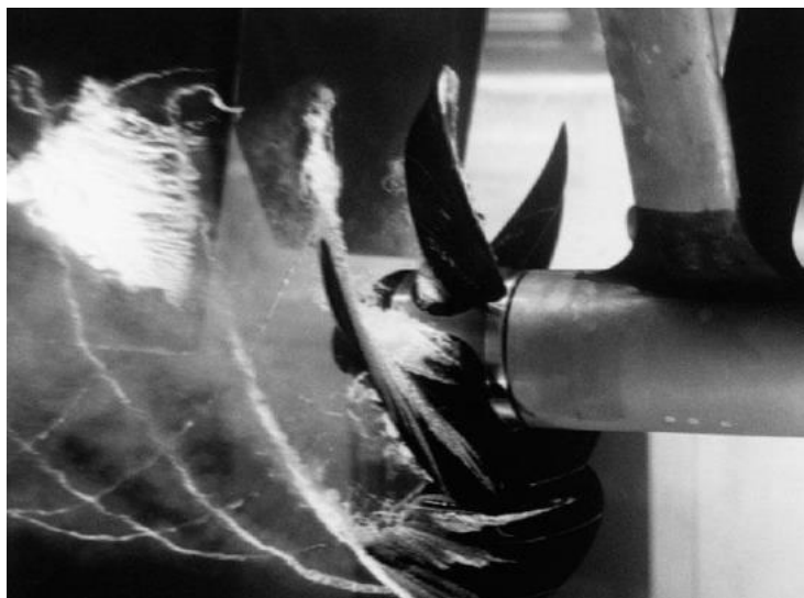
Εικόνα 3.12 Φαινόμενο σπηλαίωσης
