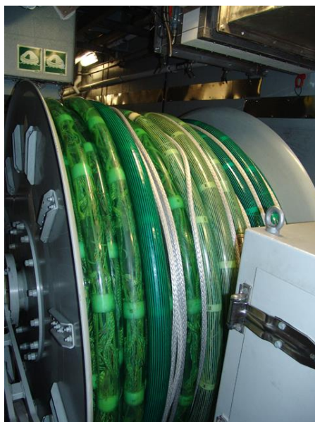
Εικόνα 3.14 Καλώδιο συστοιχίας υδροφώνων μήκους 1300m με υδρόφωνα ανα ένα μέτρο ( http://www.tboverse.us )
