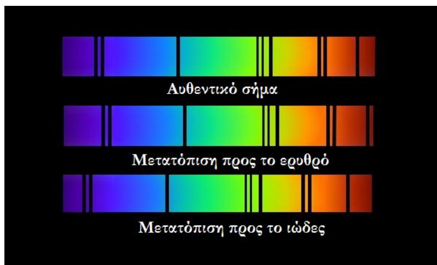
Εικόνα 5.12 Φαινόμενο Doppler σε γραμμικό φάσμα απορρόφησης
