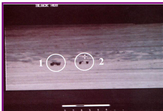
Φωτ. 4-13, Όχημα με απλή και με αντί-IR βαφή.
