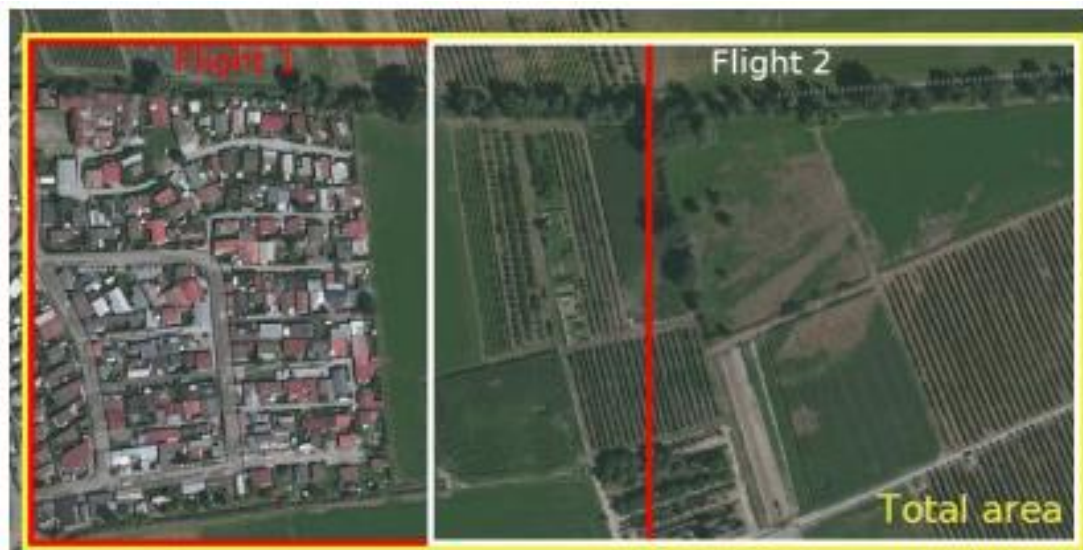
Εικόνα 3.5 Παράδειγμα πολλαπλής σάρωσης περιοχής
