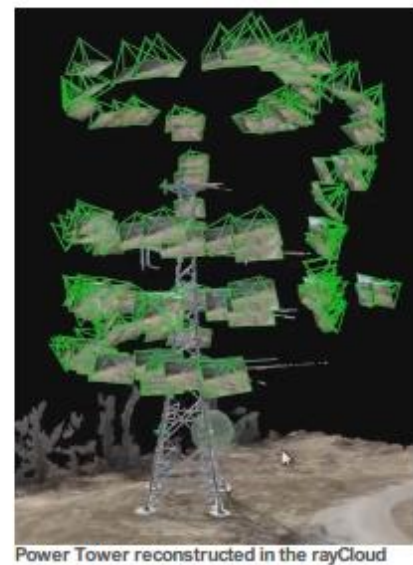
Εικόνα 3.7 Παράδειγμα 3D ανασχηματισμού ενός πυλώνα
