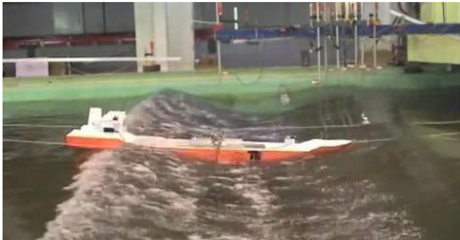
Εικόνα 1.3 Πειραματική προσομοίωση διαδικασίας δημιουργίας των γιγάντιων κυμάτων
