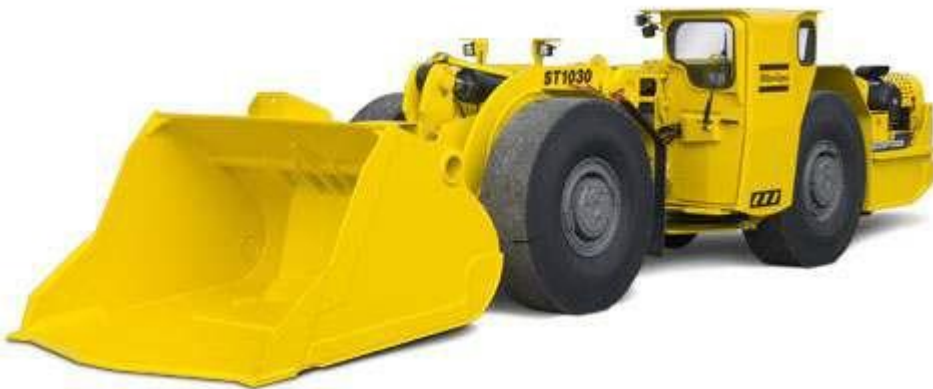
εικόνα 38: Ο φορτωτής Scooptram ST1030 της Atlas Copco.
