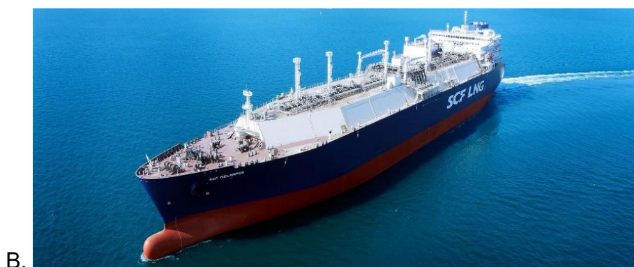
Εικόνα 2. Παράδειγμα LNG carrier A. Moss sphere design B. Membrane design
