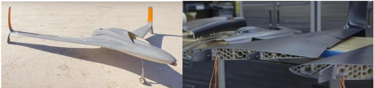
Εικόνα 73. 3D εκτυπωμένο UAV από την Stratasys και την Aurora Flight Sciences
