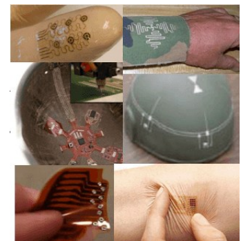
Εικόνα 81. 3D τυπωμένα κυκλώματα και κεραία
