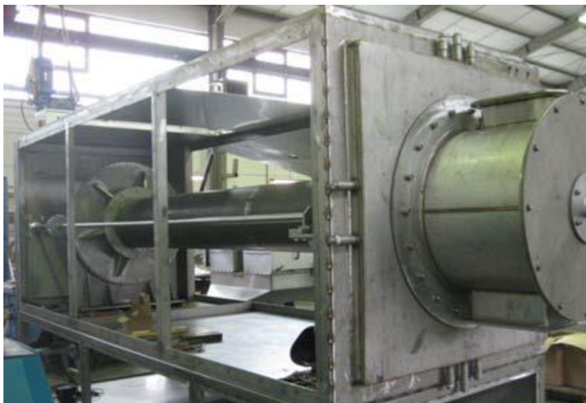
Εικόνα 5.1.2 Αεριοποιητής περιστρεφόμενου τυμπάνου υπερυψηλής θερμοκρασίας (5 ton/day) (Πηγή: Gikas, 2016)
