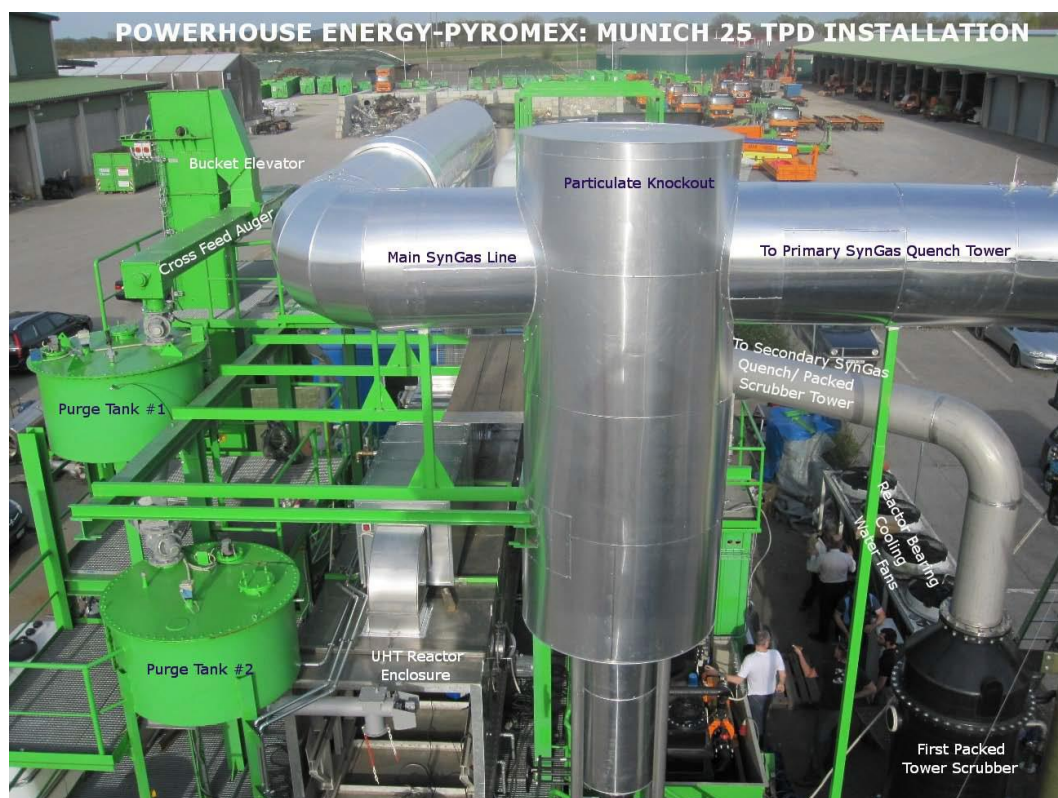
Εικόνα 5.1 Ολοκληρωμένη εγκατάσταση αεριοποίησης δυναμικότητας 25 ton/day (Πηγή: Gikas, 2016)
