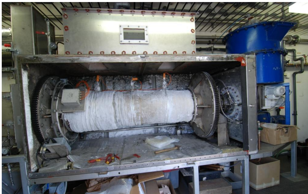
Εικόνα 4.1.1.2 Πειραματικός Αεριοποιητής Rotary drum (Πηγή: Gikas, 2016)
