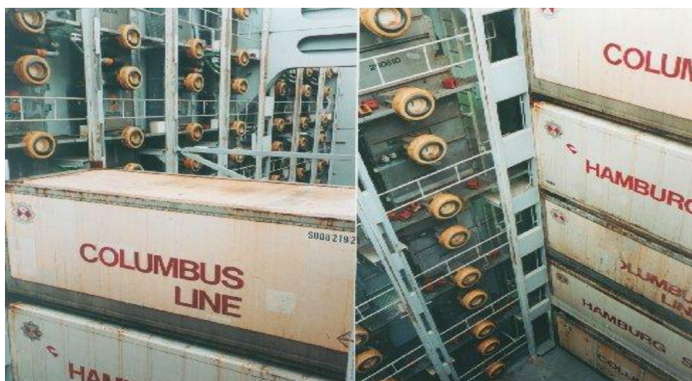
Εικόνα 12: Μόνιμες παροχές ηλεκτρικής ενέργειας για ψύξη των εμπορευματοκιβωτίων στο κατάστρωμα πλοίου
