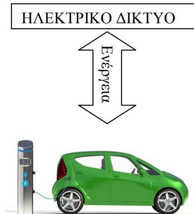
Εικόνα 9: Ροή ενέργειας μεταξύ συνδεδεμένων ηλεκτρικών οχημάτων και ηλεκτρικού δικτύου του λιμένα
