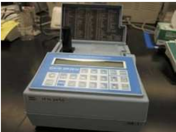
Εικόνα 10: Φασματοφωτόμετρο της εταιρίας HACH
