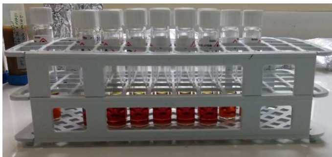
Εικόνα 9: Χημική ανάλυση προσδιορισμού COD
