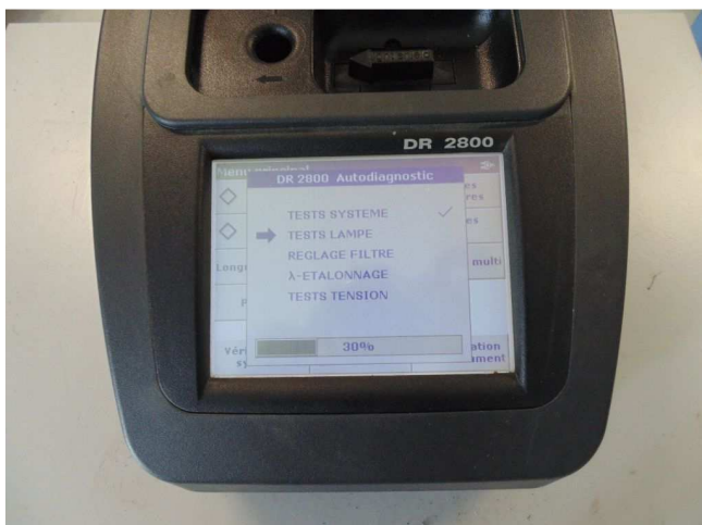
Εικόνα 11: Φασματοφωτόμετρο DR 2800 Portable spectrophotometer της εταιρίας HACH
