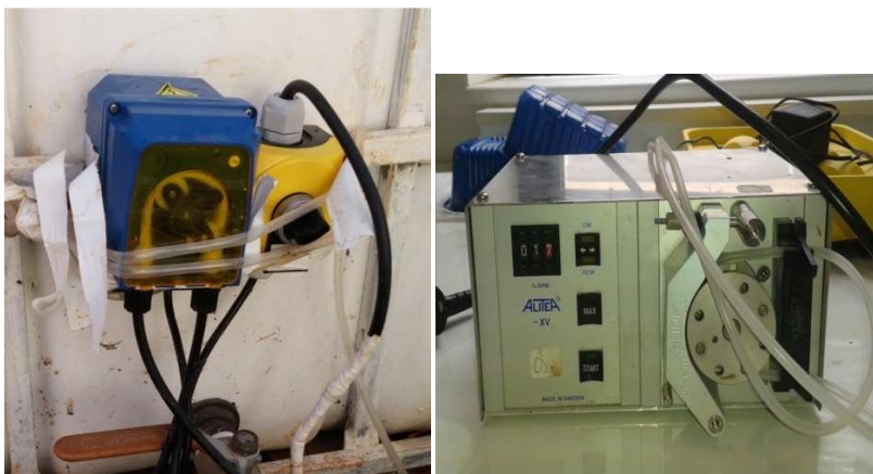
Εικόνα 6: Περισταλτικέςδοσιμετρικέςαντλίεςα) εταιρίας seko τύπου PR7 β) εταιρίας BiOENGiNEERiNG τύπου ALITEA-XV
