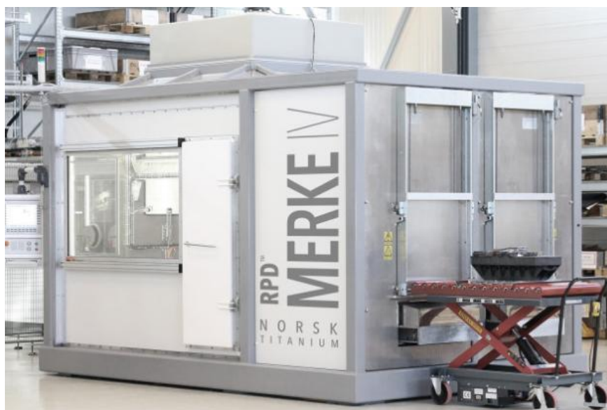
Εικόνα 48 Η μηχανή RPD TM MERKE IV της Norsk Titanium (Build Size 900mm x 600mm x 300mm)
