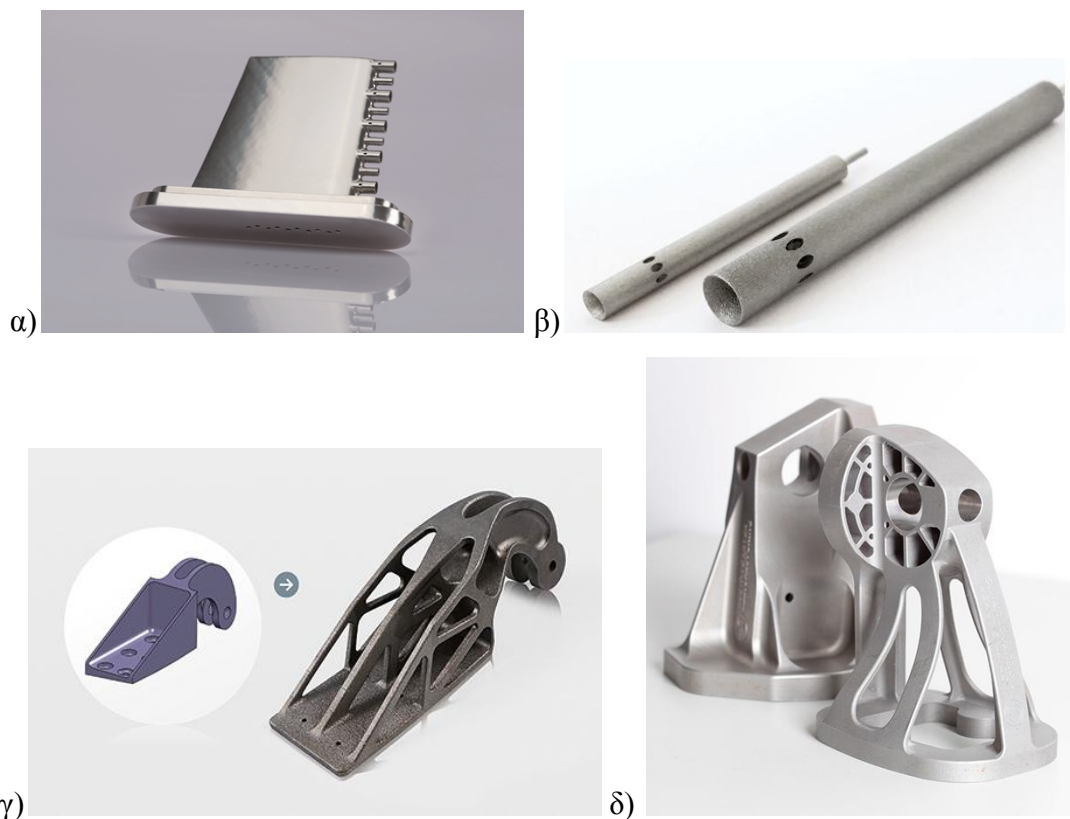
Εικόνα 63 Αεροπορικά εξαρτήματα κατασκευής εταιρίας EOS με μέθοδο DMLS α) Όργανο μέτρησης της ροής αέρα β) Όργανο μέτρησης συνολικής πίεσης ενός αεροστροβίλου γ) Bracket χάλυβα συμβατικής σχεδίασης (αριστερά) και αλουμινίου βελτιστοποιημένης τοπολογίας (δεξιά) δ) Bracket ανοξείδωτου χάλυβα συμβατικής σχεδίασης (πίσω) και βελτιστοποιημένης τοπολογίας αεροσκάφους Airbus A380
