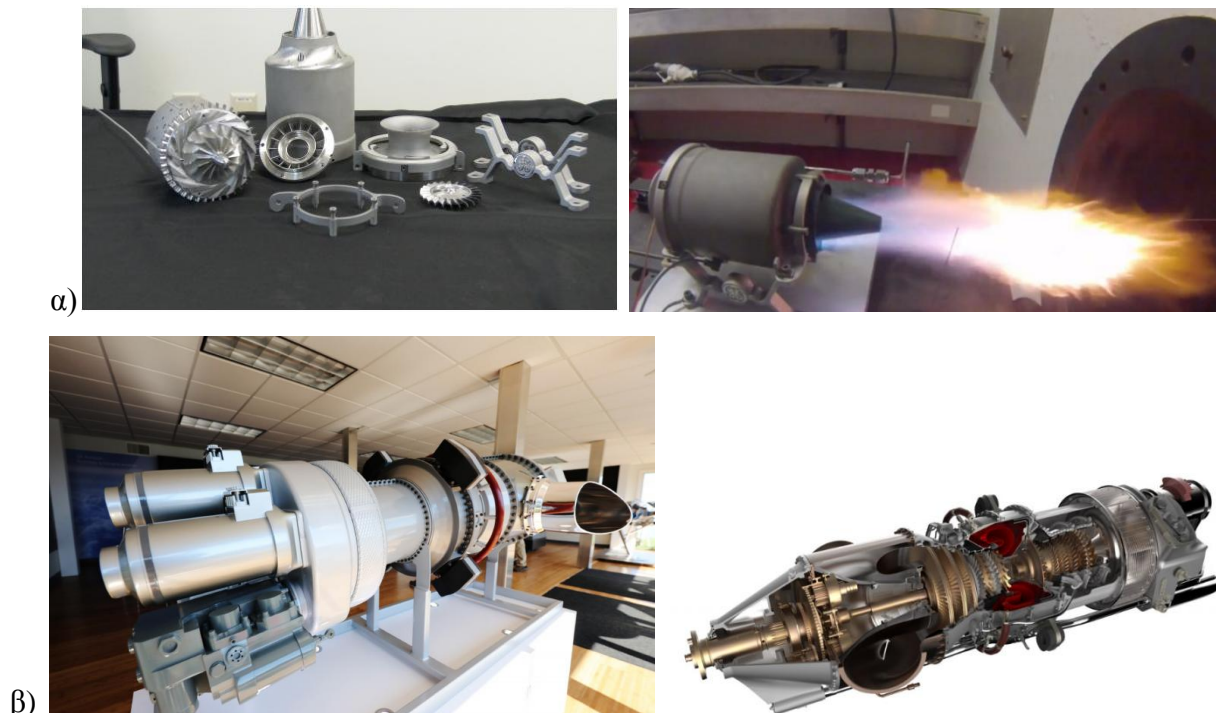
Εικόνα 56α) Ο μίνι κινητήρας jet της GE αποτελούμενος εξολοκλήρου από 3D printed εξαρτήματα β) Ο κινητήρας Advanced Turboprop (ATP) της GE όπως παρουσιάστηκε στο Oshkosh airshow προορισμένος για το αεροσκάφος Cessna Denali της Textron Aviation
