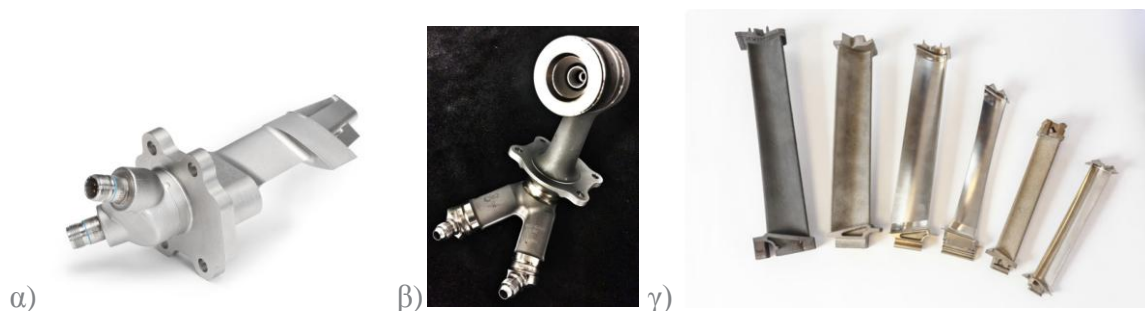
Εικόνα 55 α) 3D Printed Housing για τον T25 Sensor που βρίσκεται στην είσοδο του συμπιεστή υψηλής πίεσης κινητήρων jet της εταιρίας GE β) 3D Printed Fuel Nozzle εταιρίας GE για τους κινητήρες GE9X και CFM LEA γ) Πτερύγια τουρμπίνας χαμηλής πίεσης κατασκευασμένα με την μέθοδο Electron Beam Melting από υλικό TiAl για τους κινητήρες GE9X της GE
