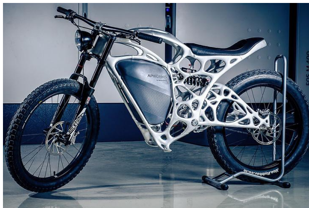
Εικόνα 50 Η πρώτη 3D printed μοτοσικλέτα «Light Rider» βάρους μόλις 35 κιλών, κατασκευασμένη από Scalmalloy (ειδικό κράμα αλουμινίου που συνδυάζει το χαμηλό βάρος του αλουμινίου και την αντοχή του τιτανίου) από την εταιρία Apworks που είναι θυγατρική της Airbus. 54
