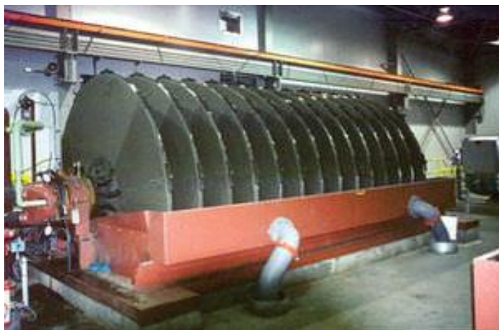
3-7 Τυπική διάταξη disc filter (FLSmidth)
