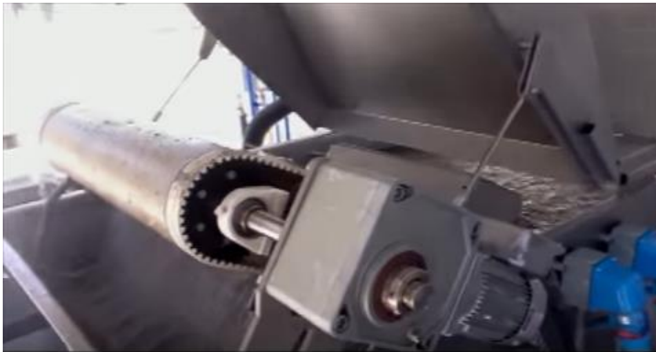
4-3 Μικροκόσκινο σε λειτουργία (Hydro International)
