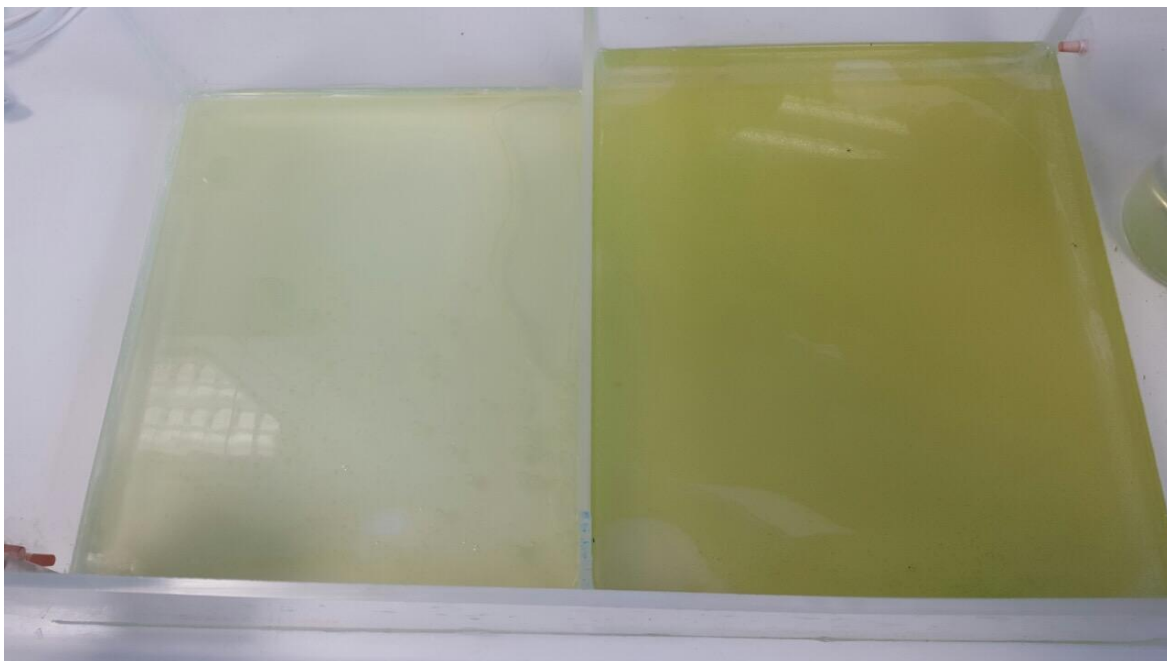
Εικόνα 5.2: Φωτο-βιοαντιδραστήρας Plexiglass κατά την φάση αδειάσματος του νερού του πρώτου τμήματος.
