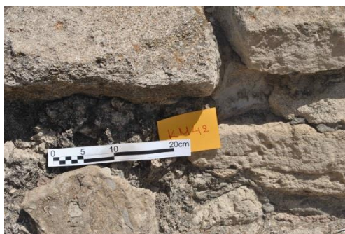
Σχήμα 47: Φωτογραφική απεικόνιση δείγματος KM42: (α) σημείου δειγματοληψίας δείγματος και (β) ληφθέντος δείγματος.
