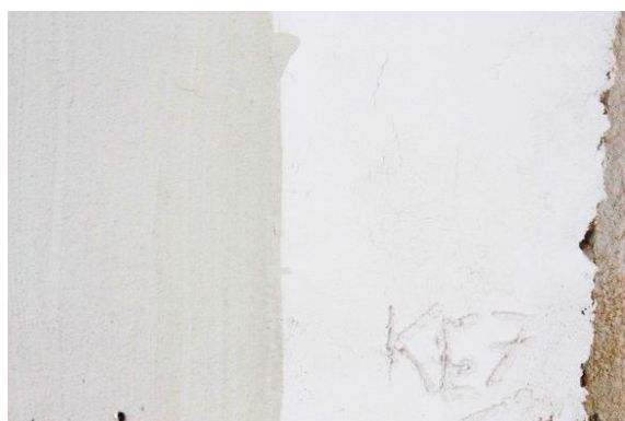
Σχήμα 181: Οι δοκιμές KE7 και KE8 μετά από 7 ημέρες από την εφαρμογή τους. Είναι εμφανής η παρουσία ρηγματώσεων, εντονότερες στο επίχρισμα KE8.
