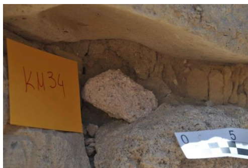
Σχήμα 39: Φωτογραφική απεικόνιση δείγματος KM34: (α) σημείου δειγματοληψίας δείγματος και (β) ληφθέντος δείγματος.
