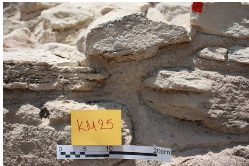
Σχήμα 30: Φωτογραφική απεικόνιση δείγματος KM25: (α) σημείου δειγματοληψίας δείγματος και (β) ληφθέντος δείγματος.
