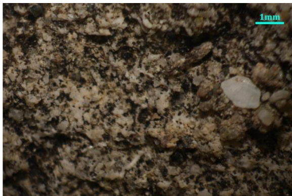
Σχήμα 97: Φωτογραφίες του δείγματος KM7Λ από το οπτικό μικροσκόπιο.
