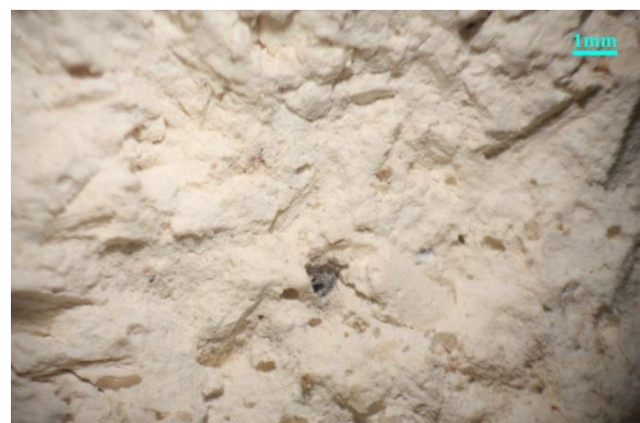
Σχήμα 68: Φωτογραφίες του δείγματος KM14 από το οπτικό μικροσκόπιο.
