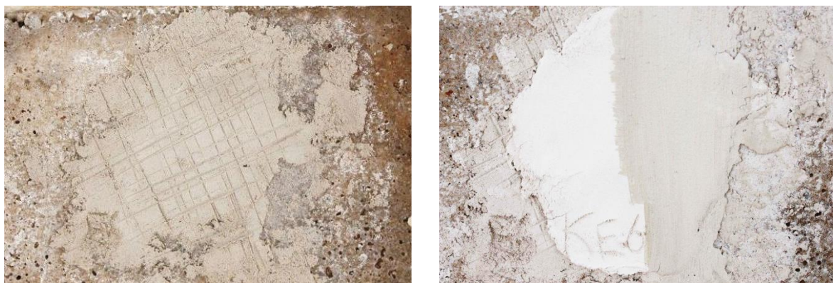
Σχήμα 183: Η επικρατέστερη δοκιμή ΚΕ6 κατά στάδια: αριστερά εφαρμογή υποστρωματικού κονιάματος και δεξιά: τελικό αποτέλεσμα με βαφή πηλοχώματος, έπειτα από 7 ημέρες.
