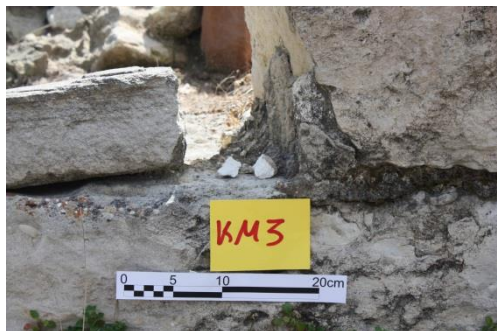
Σχήμα 8: Φωτογραφική απεικόνιση δείγματος KM3: (α) σημείου δειγματοληψίας δείγματος και (β) ληφθέντος δείγματος.
