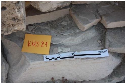
Σχήμα 26: Φωτογραφική απεικόνιση δείγματος KM21Λ: (α) σημείου δειγματοληψίας δείγματος και (β) ληφθέντος δείγματος.
