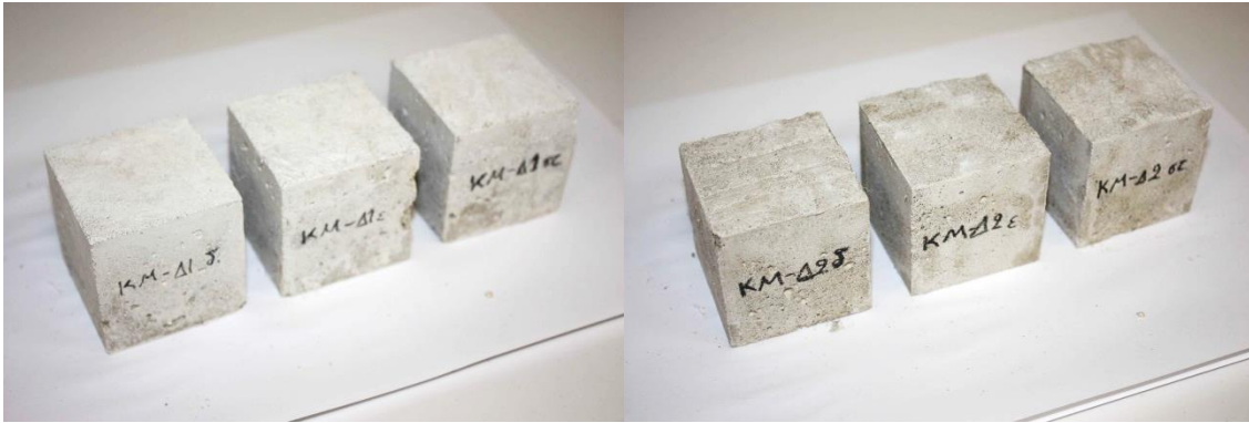
Σχήμα 176: Κυβικά δοκίμια 5x5x5 cm, για τις δοκιμές τριχοειδούς αναρρίχησης και κορεσμού, των συνθέσεων KM-Δ1 (αριστερά) και KM-Δ2 (δεξιά).
