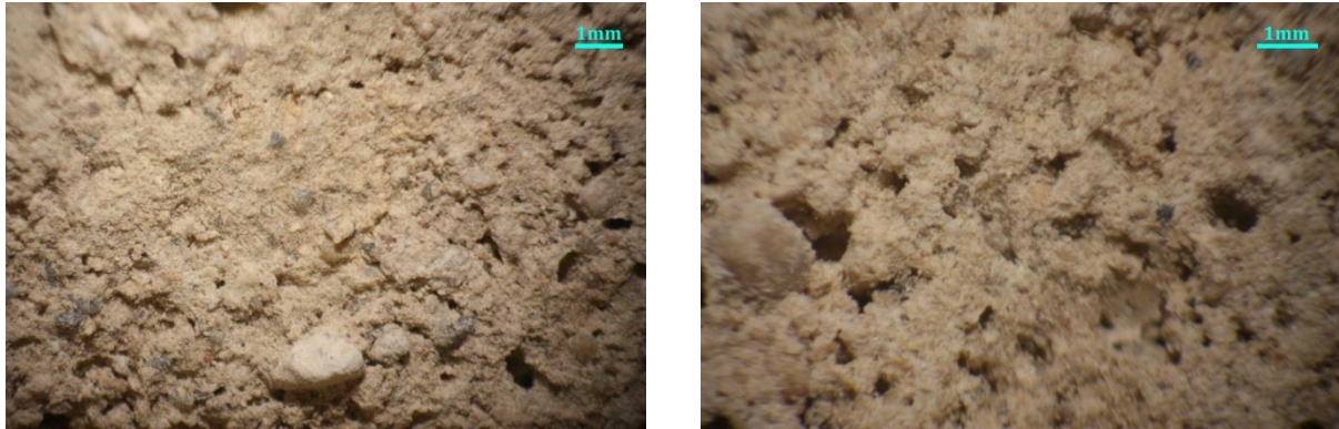
Σχήμα 88: Φωτογραφίες του δείγματος KM40 από το οπτικό μικροσκόπιο.
