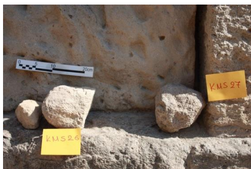
Σχήμα 31: Φωτογραφική απεικόνιση δείγματος KM26Λ: (α) σημείου δειγματοληψίας δείγματος και (β) ληφθέντος δείγματος.
