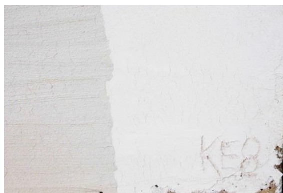
Σχήμα 181: Οι δοκιμές KE7 και KE8 μετά από 7 ημέρες από την εφαρμογή τους. Είναι εμφανής η παρουσία ρηγματώσεων, εντονότερες στο επίχρισμα KE8.
