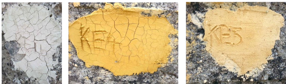
Σχήμα 179: Οι δοκιμές ΚΕ1, ΚΕ4 και ΚΕ5 με σταδιακή μείωση της συμμετοχής πηλού, του λόγου Κ/Α και των εμφανιζόμενων ρηγματώσεων.
