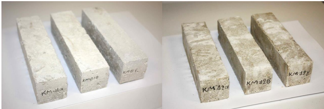
Σχήμα 173: Δοκίμια ελέγχου μηχανικών αντοχών, των συνθέσεων KM-Δ1 (αριστερά) και KM-Δ2 (δεξιά).
