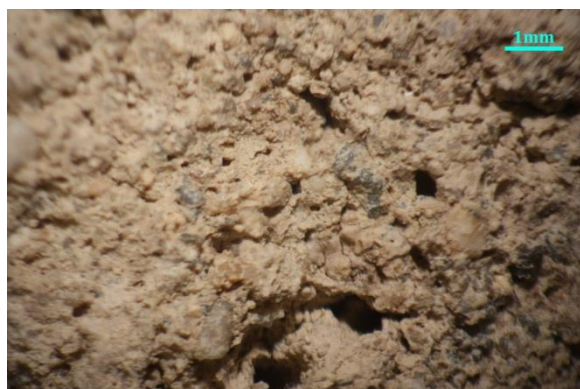
Σχήμα 82: Φωτογραφίες του δείγματος KM32 από το οπτικό μικροσκόπιο.
