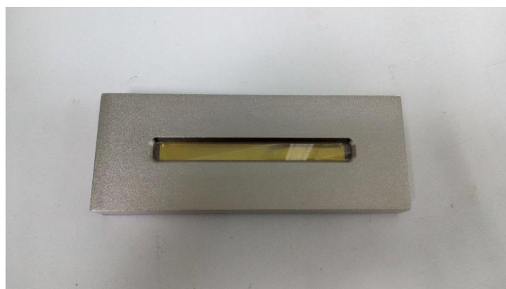
Εικόνα 15: Κυψελίδα εσωτερικής ολικής ανάκλασης ATR
