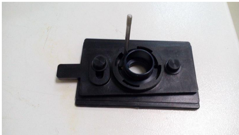
Εικόνα 22: Υποδοχέας δισκίων KBr
