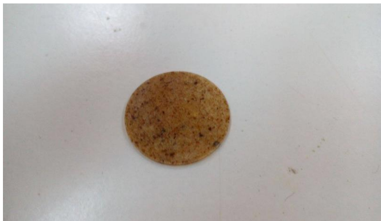
Εικόνα 25: Δισκίο KBr σε ανάμειξη με δείγμα ρητίνης
