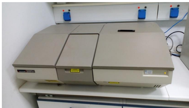
Εικόνα 12: Συσκευή Υπέρυθρης Ακτινοβολίας με Μετασχηματισμό Φουριέ (FTIR)
